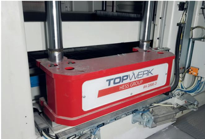
Le système de vibration consiste en une table vibrante en une partie équipée du système Variotronic.
