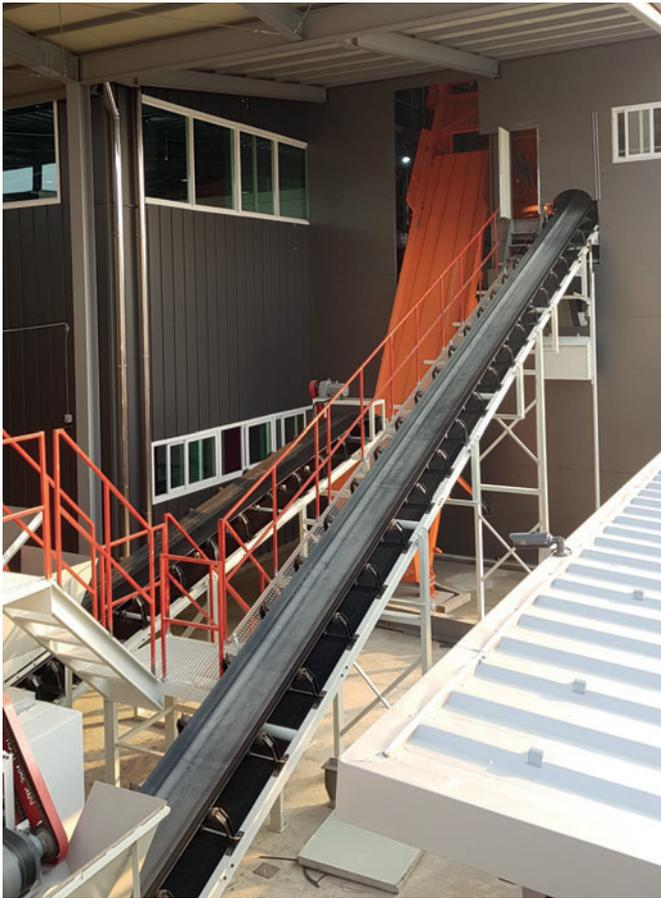
*Une bande doseuse en dessous des trémies pèse les granulats pour le béton de corps avant de les transférer à l'élévateur de bennes.*
