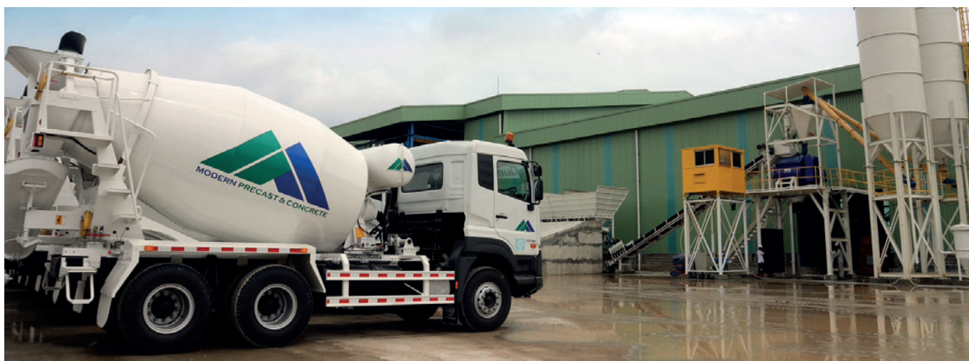
La nouvelle installation de mélange présente une capacité de 500 m 3 par équipe. Modern Precast dispose actuellement de six camions malaxeurs de 7 m 3 chacun.
