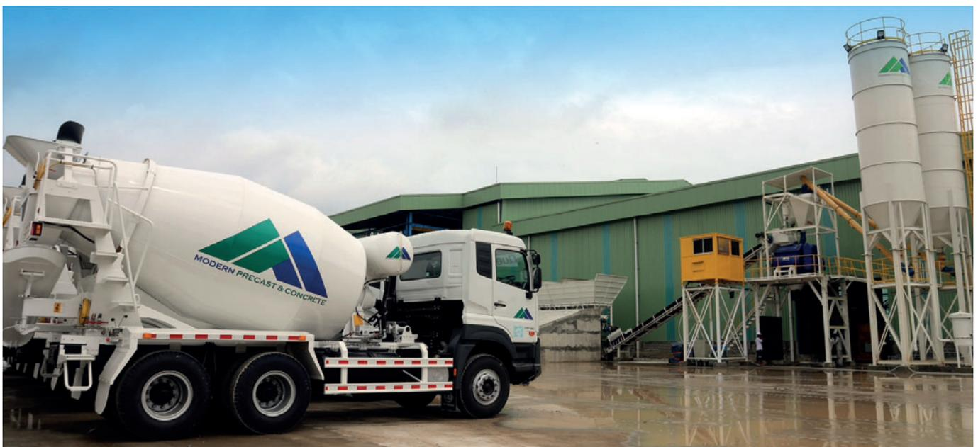
La nueva instalación mezcladora tiene una capacidad de 500 m<sup>3</sup> por turno. Modern Precast cuenta actualmente con seis camiones hormigonera de 7 m<sup>3</sup> en pleno funcionamiento.
