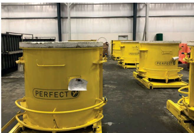
Perfect-Gießformen für schalungserhärtete Produkte sind bedienerfreundlich für alle erforderlichen Arbeitsschritte vom Rüsten, Befüllen bis zum Entschalen und Reinigen.
