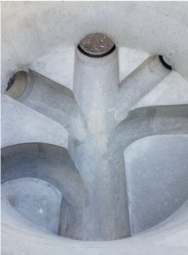
Innerhalb eines Tages können komplexe Bauteile in monolithischer Bauweise lieferfertig gestellt werden.
