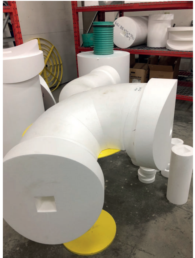
Position und Neigung der Rohranschlüsse sowie Höhe und Einmündung des Hauptgerinnes sind frei bestimmbar.
