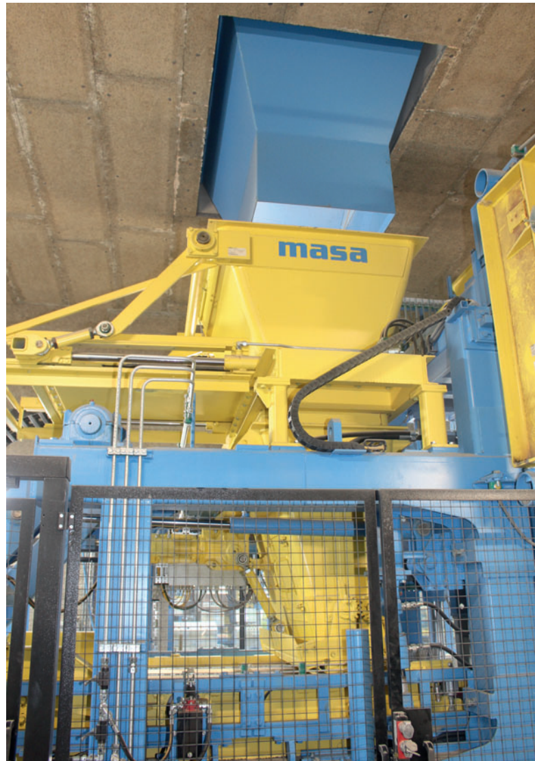
Kern- und Vorsatzsilos sind mit Wiegezellen ausgestattet.
