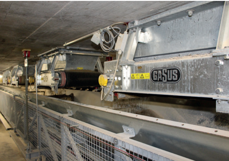
Die einzelnen Gesteinskörnungen werden bei einer Leistung von 3.000 kg/min durch Dosierbänder additiv auf einem Wiegeförderband verwogen.
