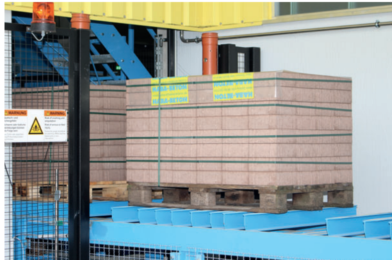
Der Pakettransport nach außen ist als Lorenumlauf ausgeführt.
