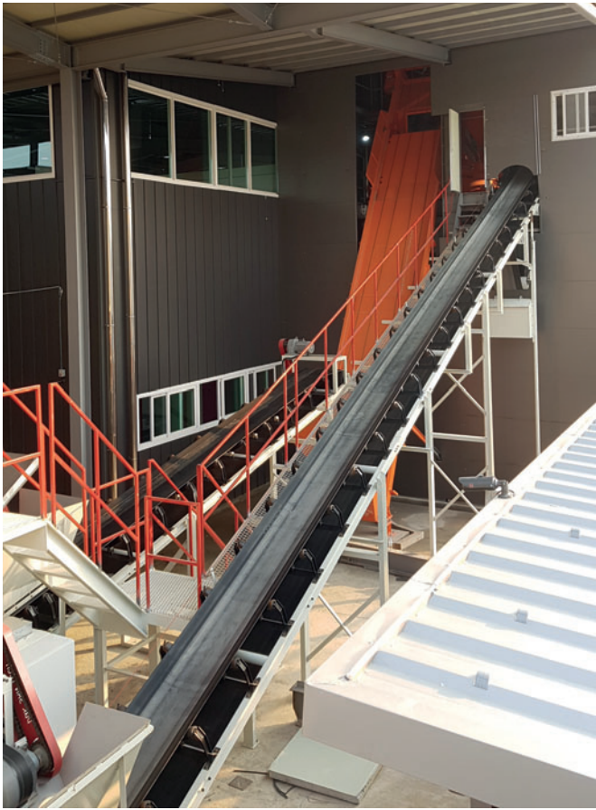
Über ein Dosierband unter den Bunkern werden die Gesteinskörnungen für den Kernbeton verwogen und in den Aufzugskübel gefüllt.
