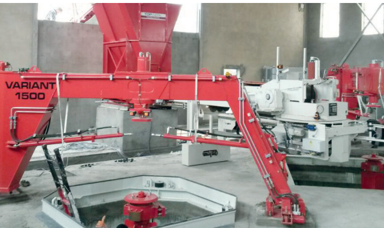
Машина для производства труб Variant 2500/1500 на этапе монтажа
