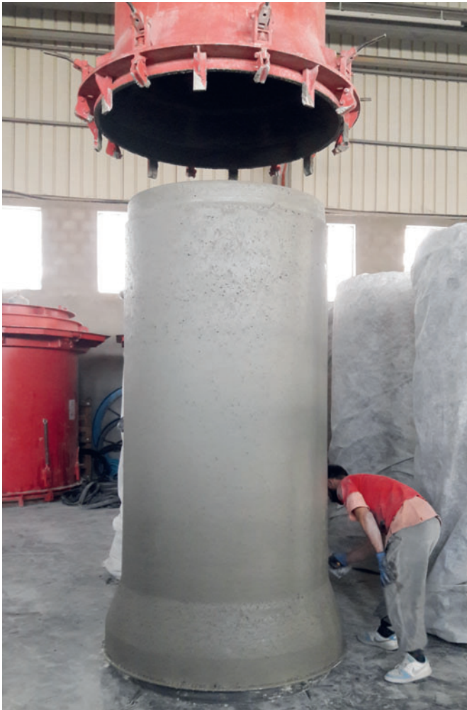
Железобетонная труба после распалубки
