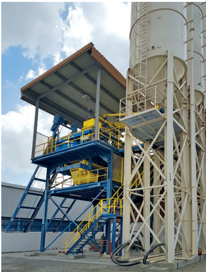
БСУ, состоящая из бетономесителей Masa PH 2000/3000 и PH 500/750
