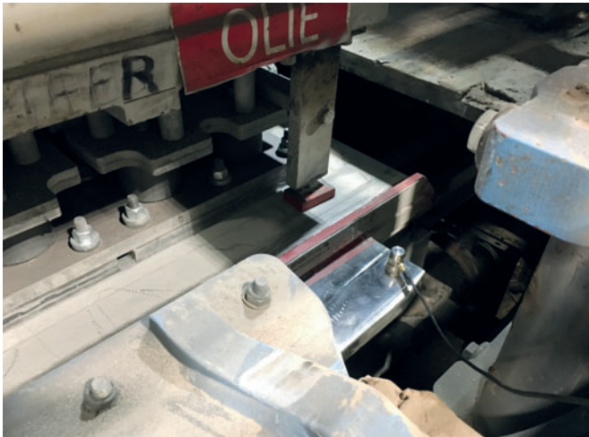
Рис. 3: Измерение вибрации на форме для выпуска бетонных блоков
