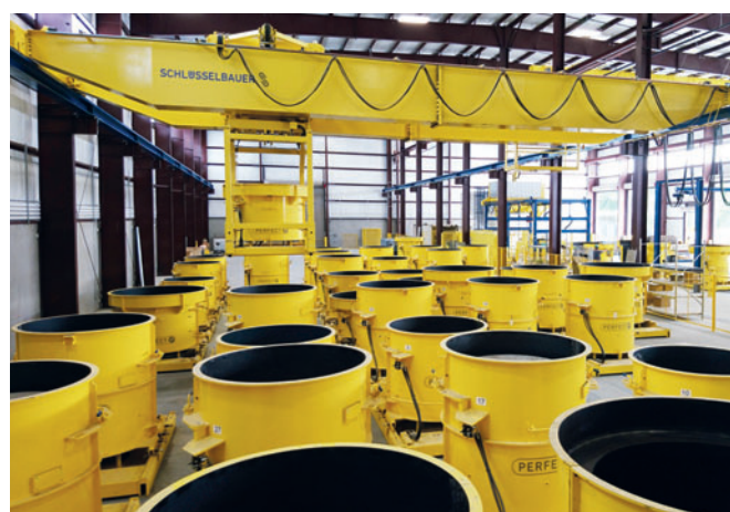
Gli stampi facili da usare forniscono la capacità e la flessibilità richieste nella fabbricazione di fondi per pozzetti
