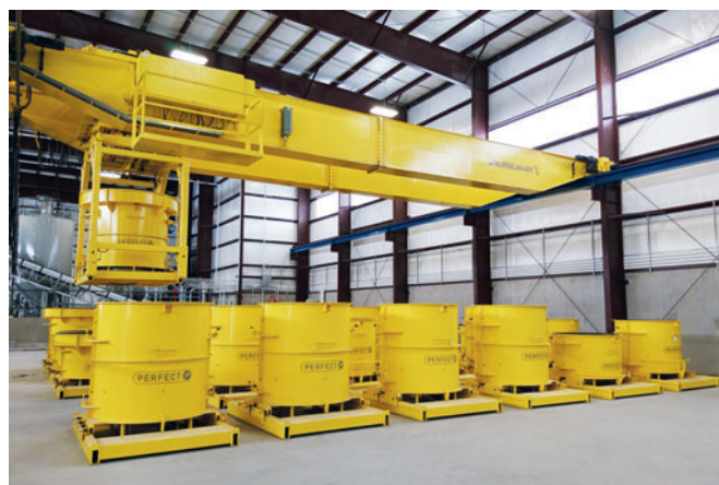
La gestione degli stampi viene eseguita da robot gru: nessuna perdita di tempo dovuta a gestione manuale, nessun traffico permanente di carrelli elevatori nella produzione
