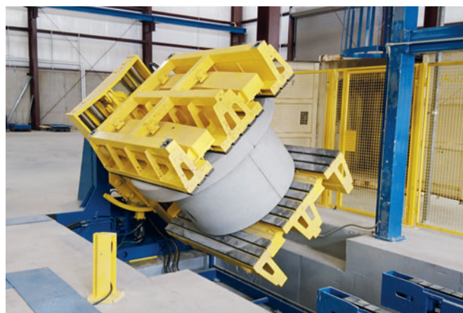
Per la gestione dei prodotti con sicurezza antigalleggiamento è stata montata una stazione di tornitura automatica
