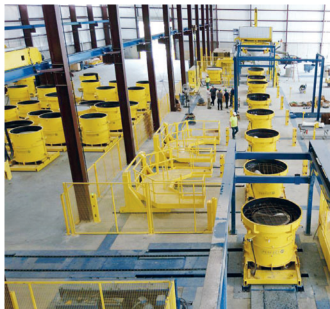
Il sistema di produzione Perfect Forming Technology presso lo stabilimento di CP&P ad Ashland consente la produzione di fondi per pozzetti più efficiente nel paese
