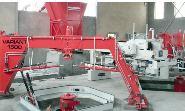
Macchina per tubi in calcestruzzo Variant 2500/1500 durante il montaggio
