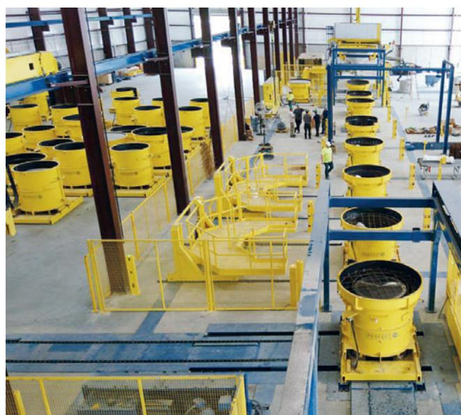
*Grâce au système de fabrication Perfect Forming Technology, l'usine CP&P d'Ashland est la plus efficace du pays pour la fabrication de fonds de regards*
