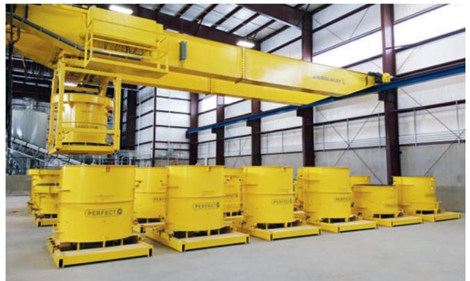
*La manipulation des moules s'effectue à l'aide d'un pont roulant robotisé : aucune perte de cadence due à une manipulation manuelle, pas de trafic permanent de chariots élévateurs sur le site de production*
