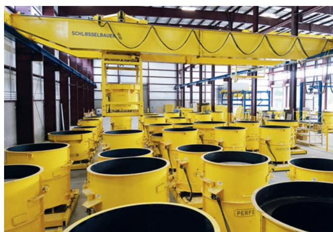
*Des moules faciles à utiliser offrent la capacité et la flexibilité requises pour la fabrication de fonds de regards*
