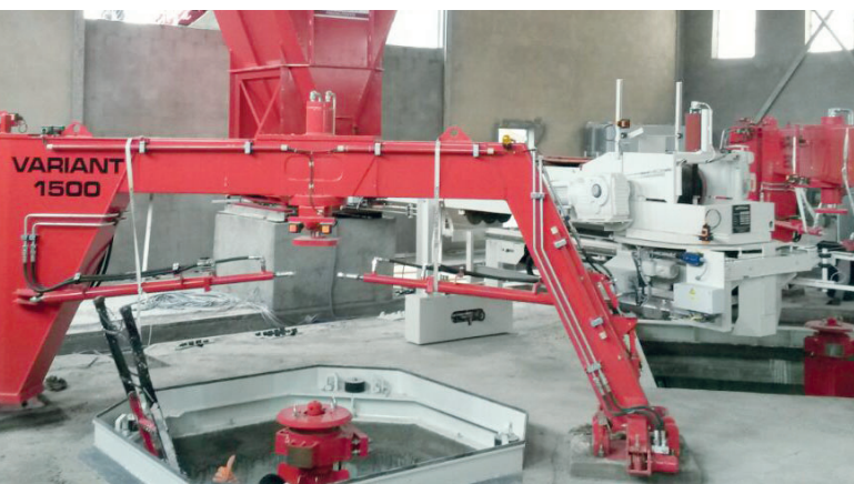
Machine pour la fabrication de tuyaux en béton Variant 2500/1500 pendant le montage
