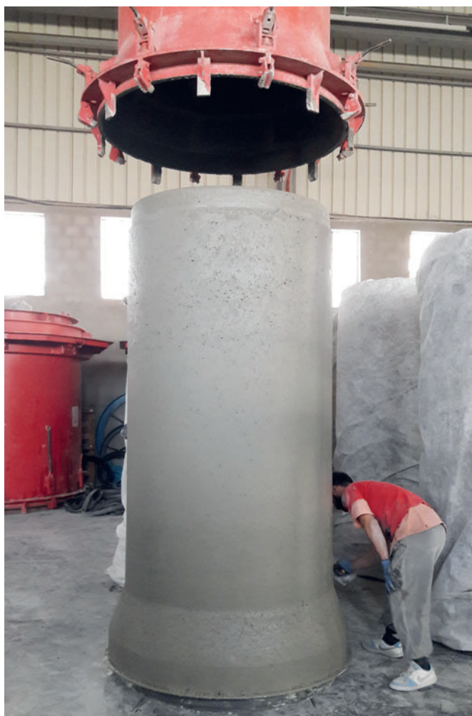
Tuyau en béton après le décoffrage
