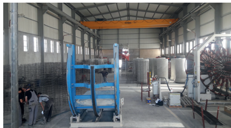
Hall de fabrication, production de tuyaux
