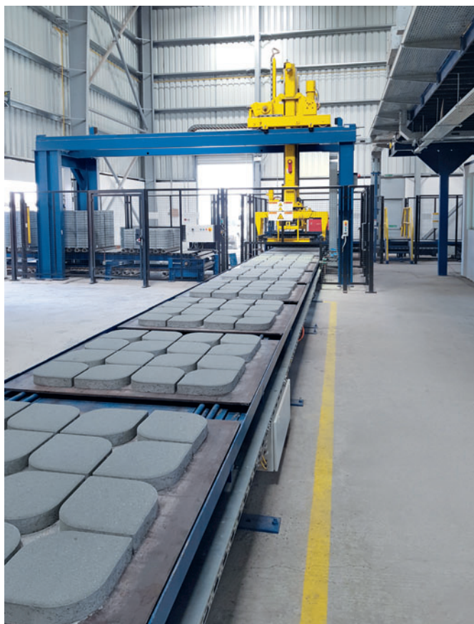
Les produits durcis sont acheminés jusqu'au Cuboter Masa avec un convoyeur de levage.
