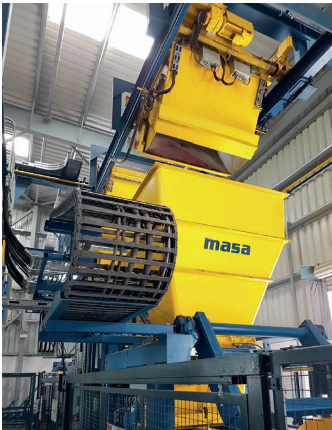
Le transport du béton depuis l'installation de mélange jusqu'à l'installation de production de blocs en béton Masa XL est assuré par un convoyeur à double benne.
