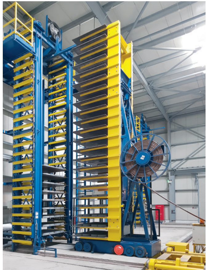
Aperçu du chariot transbordeur Masa dans l'espace de durcissement.
