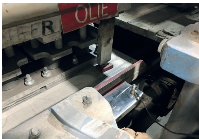
Figure 3 : mesure des vibrations sur le moule pour blocs de béton
