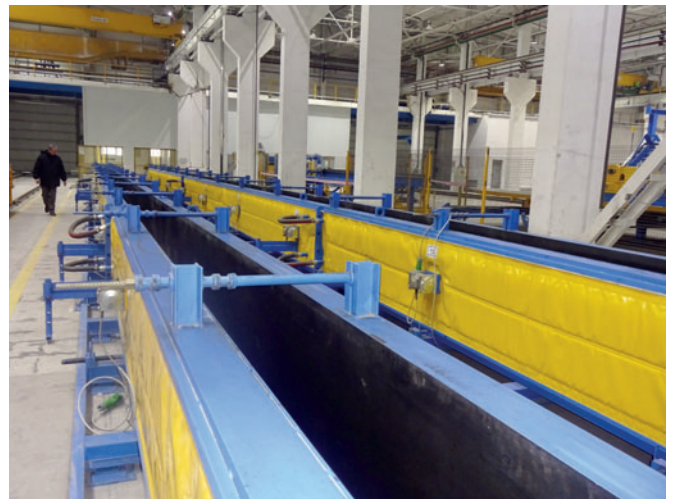
Le spécialiste du coffrage Tecnomac a fourni des moules pour la production de colonnes et de poutres en plus des batteries de coffrage.
