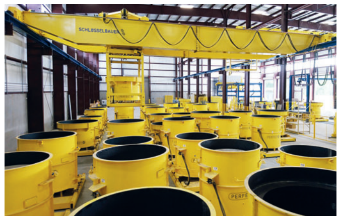
Los moldes fáciles de manipular permiten lograr la capacidad y la flexibilidad necesarias para la producción de bases para pozos
