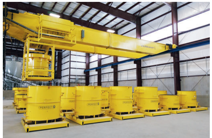
Los moldes se manipulan con grúas robóticas, de modo que no se pierde tiempo en la manipulación manual ni hay un tráfico constante de carretillas elevadoras en la planta
