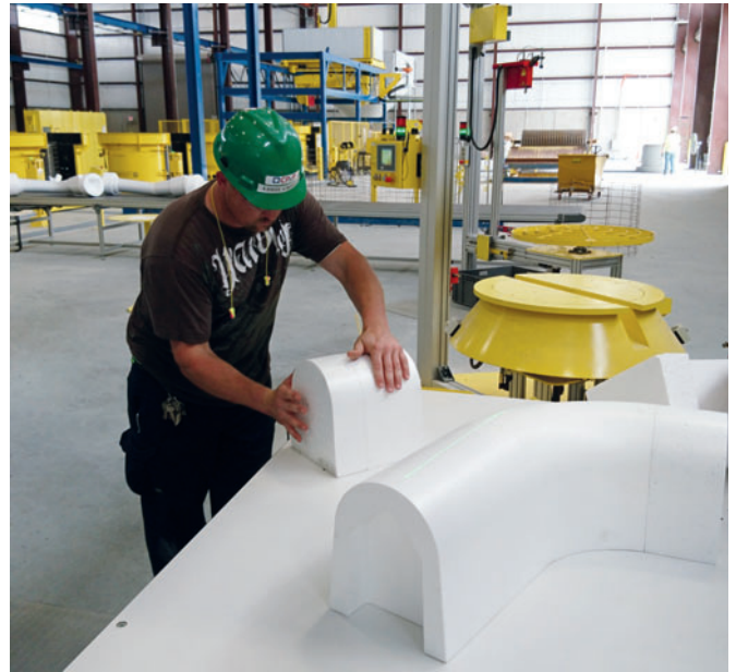
Las piezas cortadas con sierras de alambre caliente se pueden unir para crear los canales con la forma precisa
