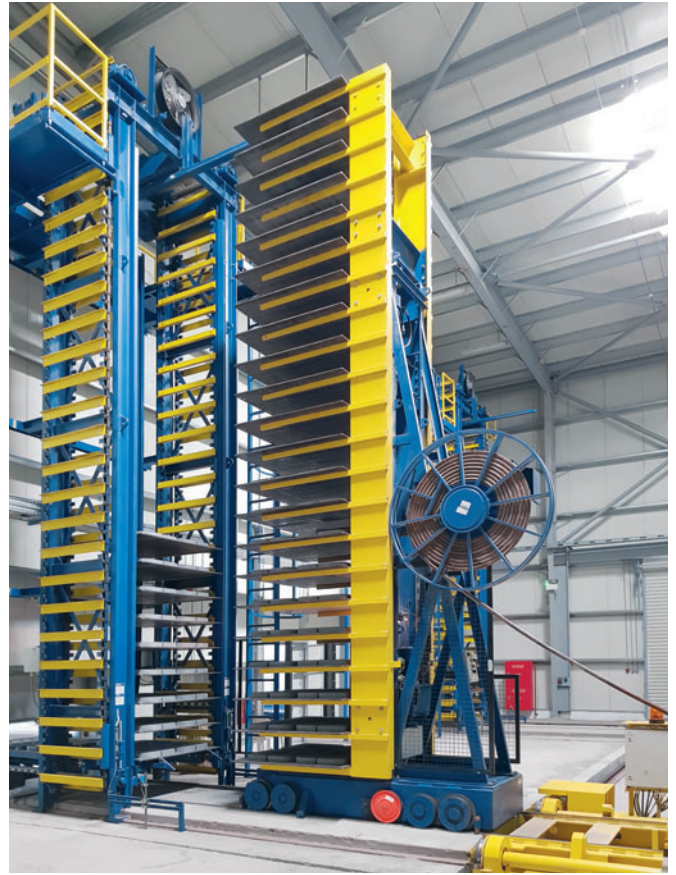
Vista del carro multiforca Masa en la zona de curado.
