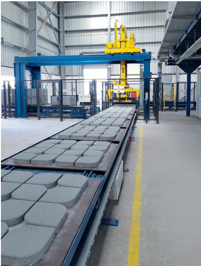
Los productos curados son transportados con un transportador de elevación libre al Masa Cuboter.
