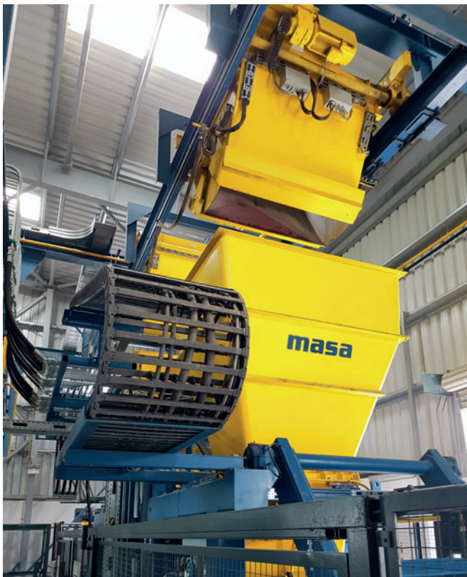
El transporte del hormigón desde la instalación de mezcla hasta la máquina de producción de bloques de hormigón Masa XL tiene lugar mediante una instalación de cuba aérea doble.
