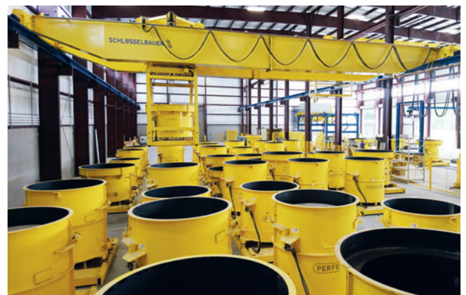
Einfach zu bedienende Gießformen sorgen für die erforderliche Kapazität und Flexibilität in der Schachtunterteilmfertigung.
