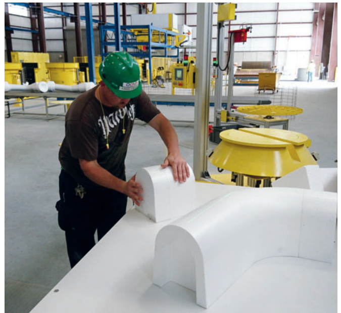
Die mit Heißdrahtsagen geschnittenen Formteile werden einfach zu den benötigten Gerinneausformungen zusammengesetzt.
