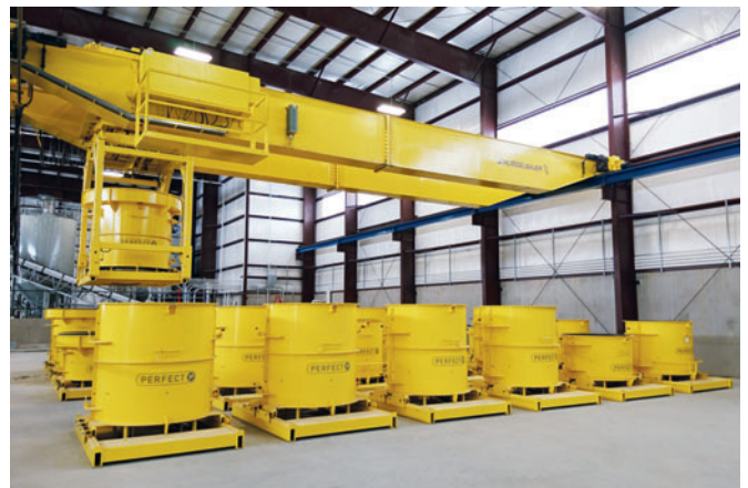
Das Handling der Gießformen wird mittels Kranroboter erledigt - kein Taktzeitverlust durch manuelle Manipulation, kein dauerhafter Staplerverkehr in der Fertigung.
