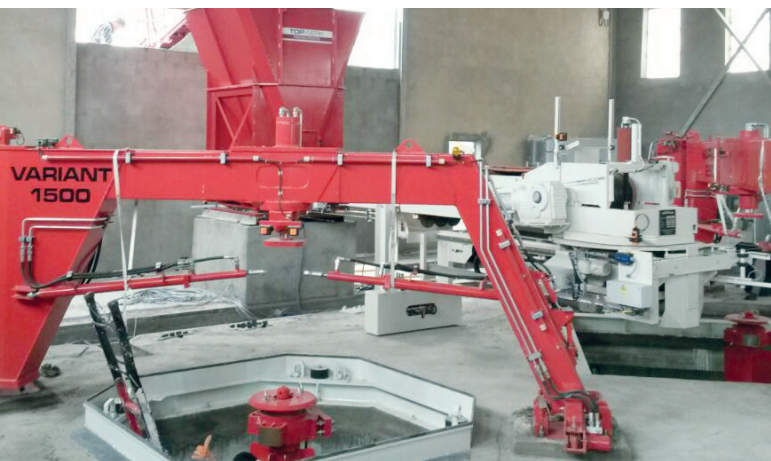
Betonrohrmaschine Variant 2500/1500 während der Montage
