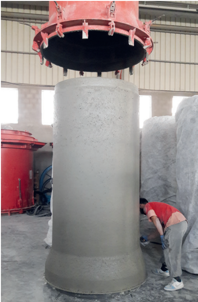
Betonrohr nach dem Entschalen
