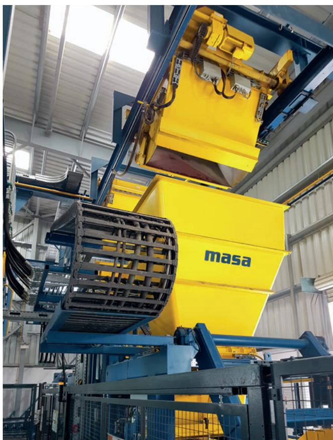
Der Transport des Betons von der Mischanlage zur Betonsteinfertigungsmaschine Masa XL erfolgt über eine Doppelkühlanlage.
