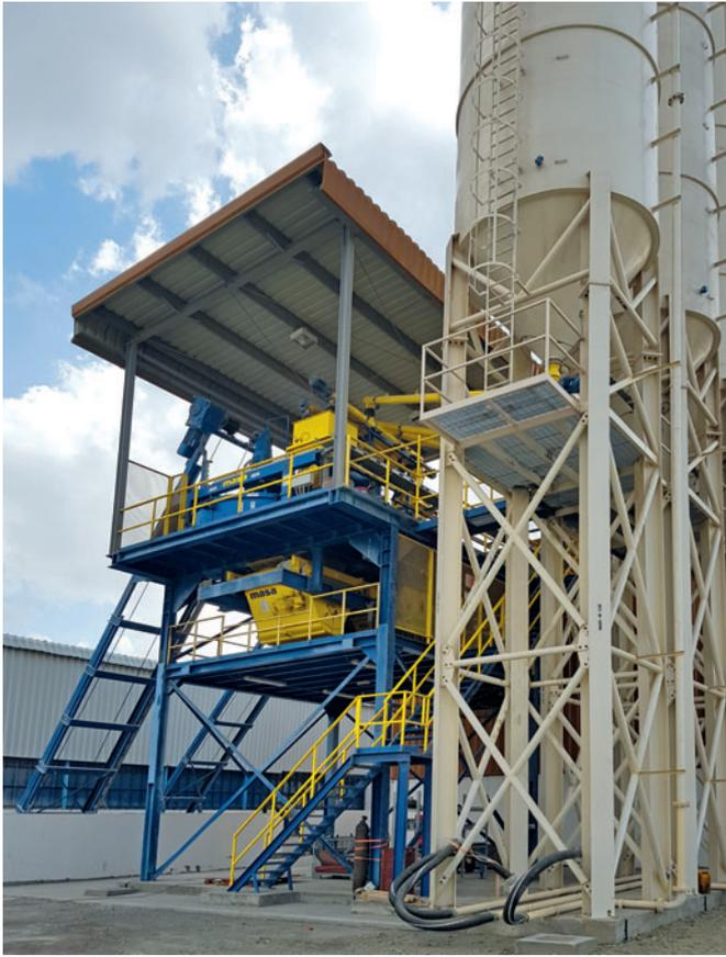
Die Mischanlage, bestehend aus den Masa-Mischern PH 2000/3000 und PH 500/750, im Außenbereich
