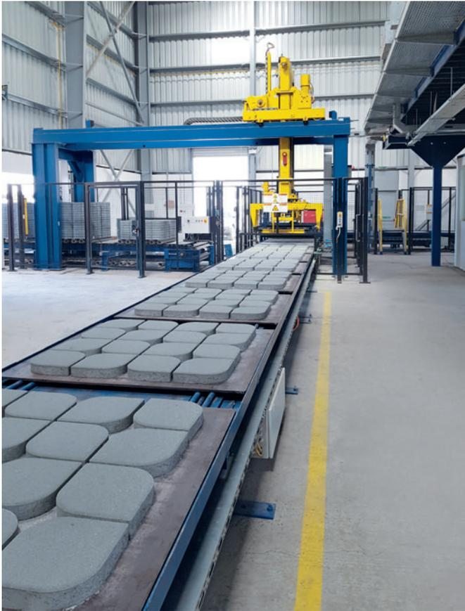
Die ausgehärteten Produkte werden mittels Freihubförderer zum Masa-Cuboter transportiert.
