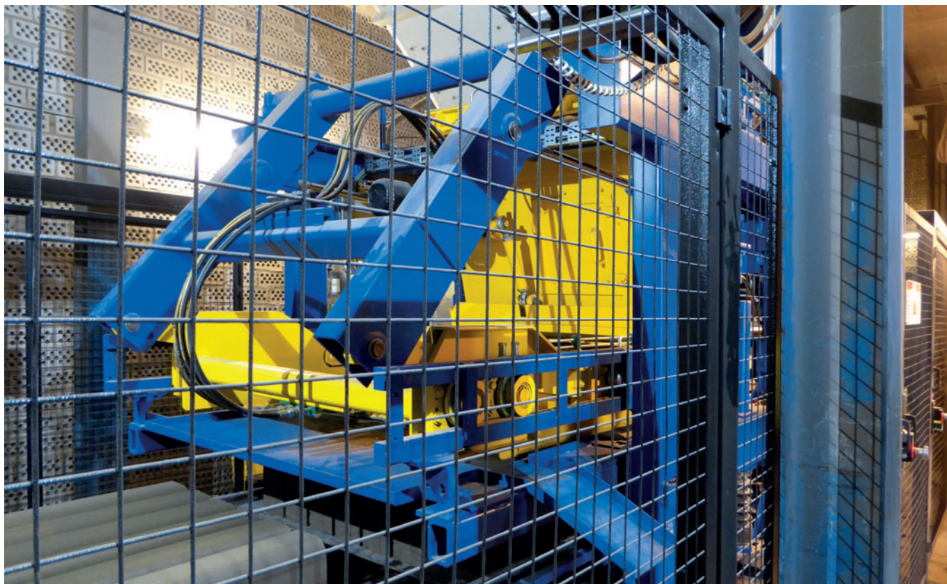
Компания Masa интегрировала вибропресс Masa L 9.1 в существующую производственную линию в Элькслебене
