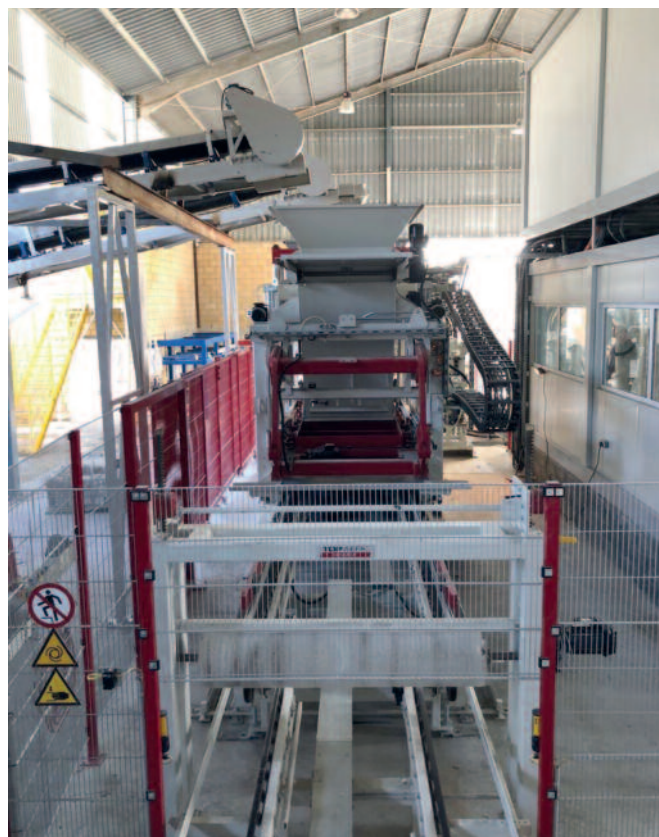
Wibroprasa RH1500 z systemem Colormix dla mieszanki licowej.
