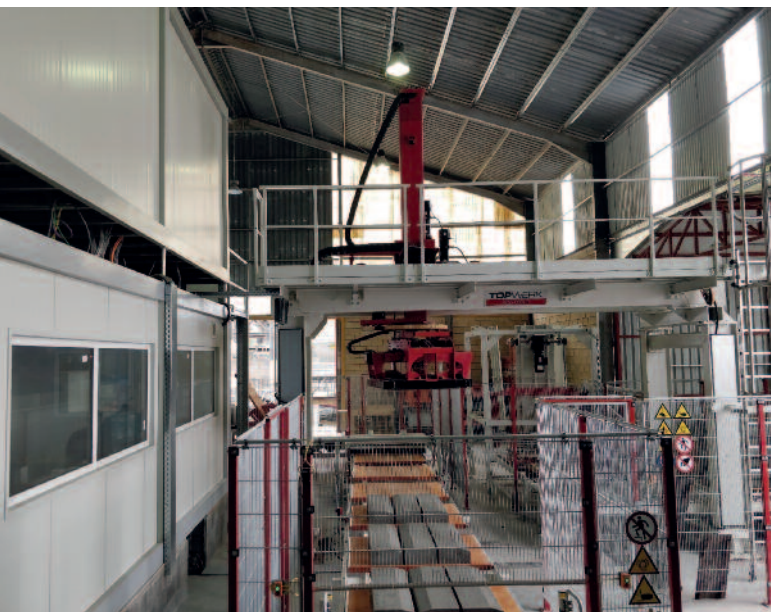
Linia sucha z elektrycznym chwytakiem pakietującym Topwerk.
