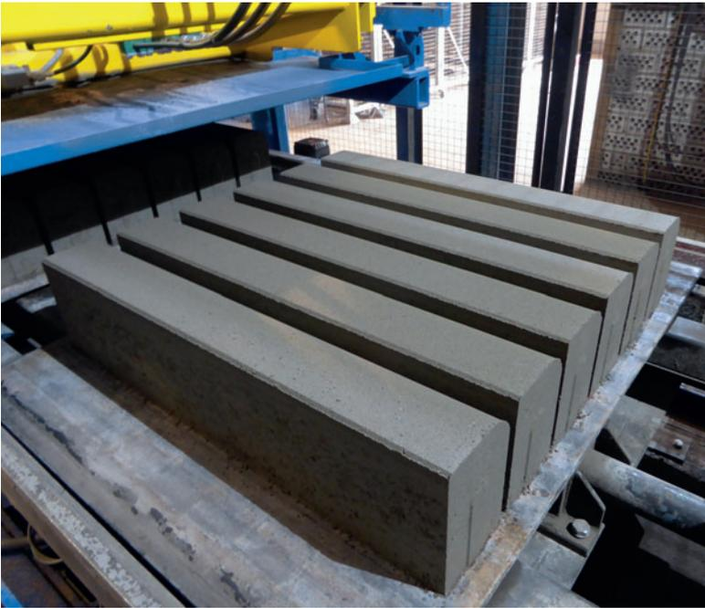
La nouvelle installation Masa L 9.1 mise en place dans l'usine d'Elxleben permet notamment de produire des bordures.
