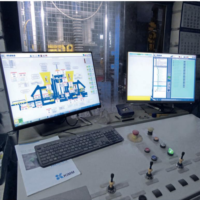
*Le logiciel modulaire de commande de l'installation Masa permettant une utilisation et une visualisation uniformes des composants a été complété par une interface de transfert de données.*
