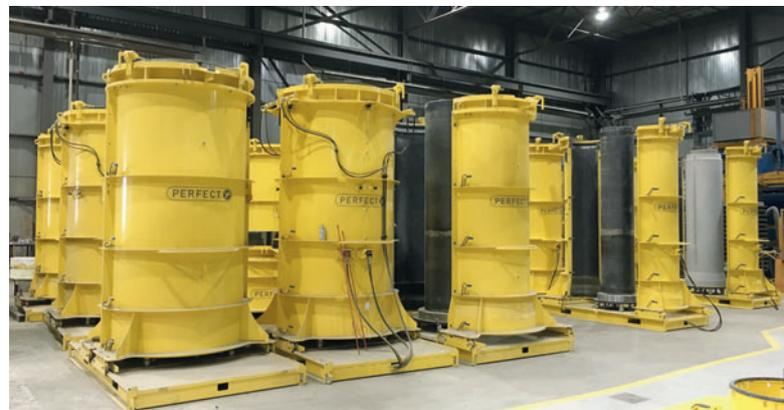
*El concepto Perfect Forming Technology es apto para componentes de infraestructuras de todo tipo, para tubos y para componentes de pozos u otras piezas de geometrías similares.*
