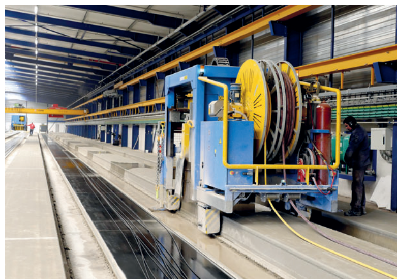
Eine Frischbetonsäge und eine Säge für ausgehärteten Beton sorgen für eine effiziente Produktionsvorbereitung sowie einen reibungslosen Produktionsprozess.
