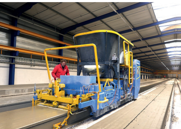
Herzstück der neuen Anlage ist der Echo Gleitfertiger S-Liner für einen vielseitigen und flexiblen Produktionsbedarf.
