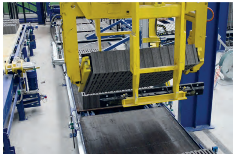
Рис. 4: Захват группировщика слоев оснащен вертикальным поворотным механизмом
