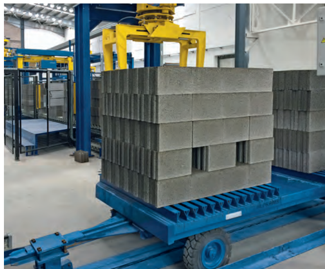
Рис. 6: Готовые пакеты с блоками укладываются на отвозную тележку, которая сопряжена с подземным конвейером
