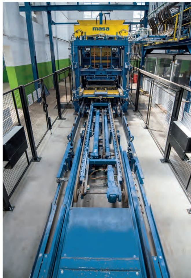
Рис. 1: Центральный компонент линии: вибропресс Masa XL 9.2 с регулируемой амплитудой (для опорного бетона) и дополнительными функциями
