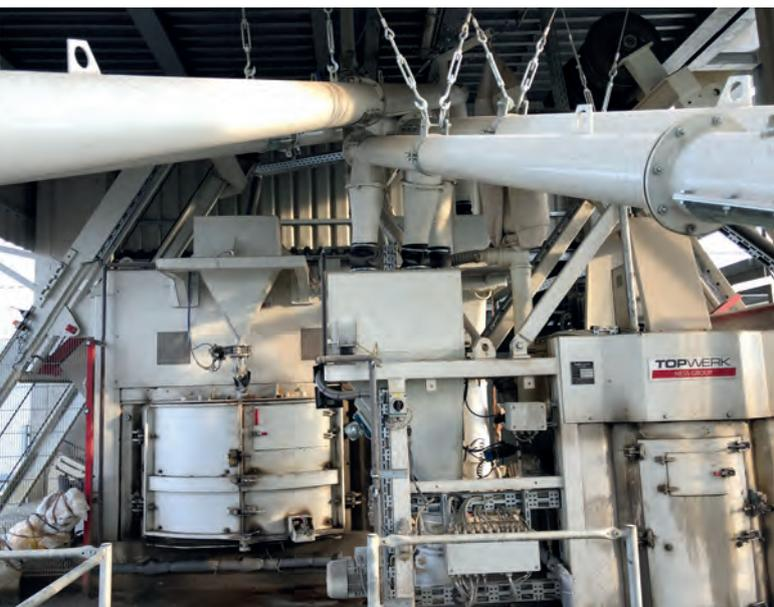
Для производства бетонной смеси были установлены бетоносмеситель Hess SM 2250 для опорного бетона и бетоносмеситель Hess SM 400 для облицовочного бетона
