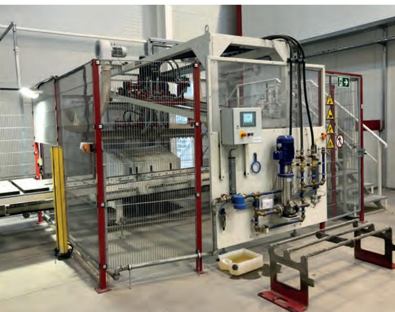
Благодаря новому промывочному устройству Hess Group изделия можно облагораживать уже на мокрой стороне производства
