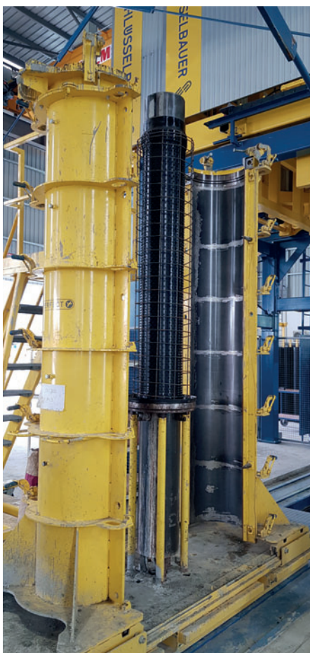
Anima della forma realizzata con Perfect Liner e cesto di armatura
