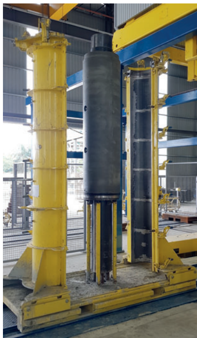
Perfect Jacking Pipe dopo il processo di indurimento
