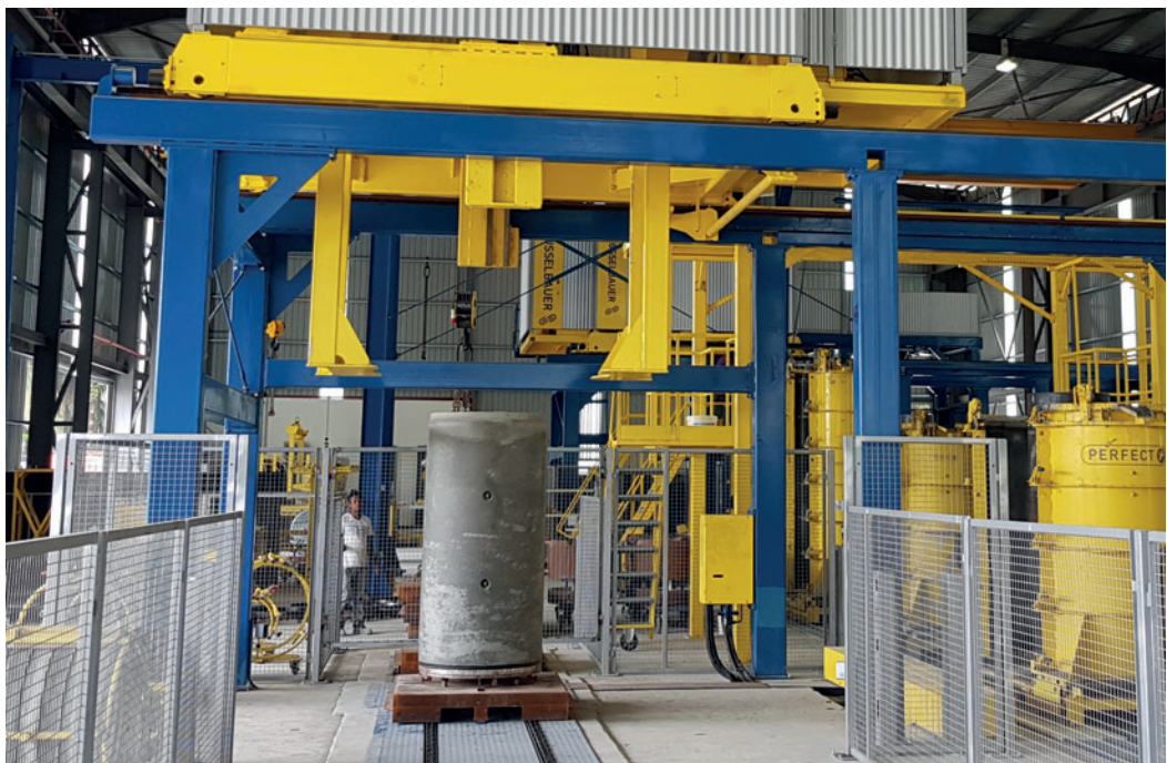
Dopo l'indurimento nello stampo i tubi di spinta vengono disarmati.
