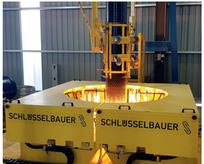
Qui vengono formate entrambe le estremità del liner in un giunto un processo termoplastico.
