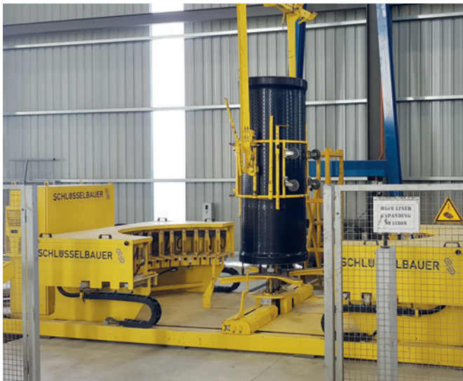
Il cilindro liner saldato viene portato dalla gru nella stazione di formatura mediante una struttura provvisoria.
