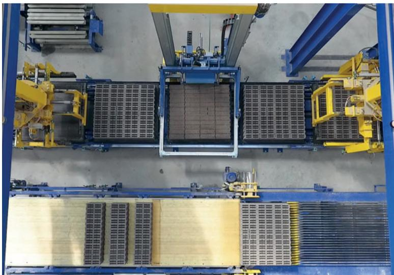
Fig. 5: Il principio dello "strato Void": una tavola scorrevole, un pressore e una tavola di separazione creano i "vuoti".
