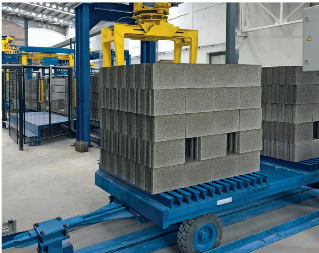
Fig. 6: I pacchi pronti vengono posizionati sui carrelli di trasporto collegati a un impianto interrato
