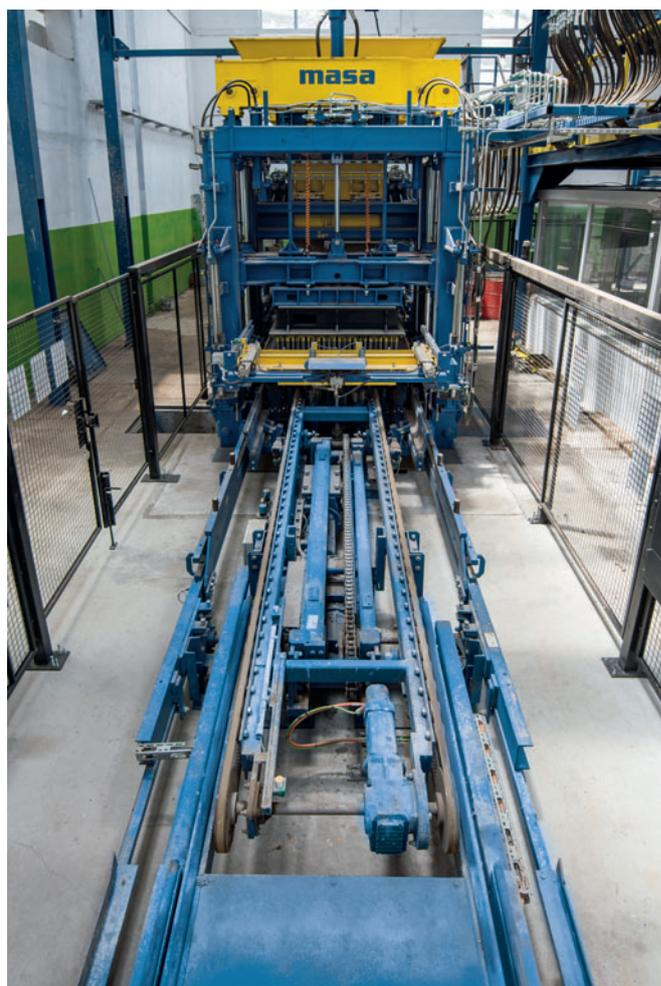
Fig. 1: Il cuore del impianto: La dotazione della Masa XL 9.2 (macchina per il calcestruzzo del strato interno) a regolazione di ampiezza comprende un altro pacchetto
