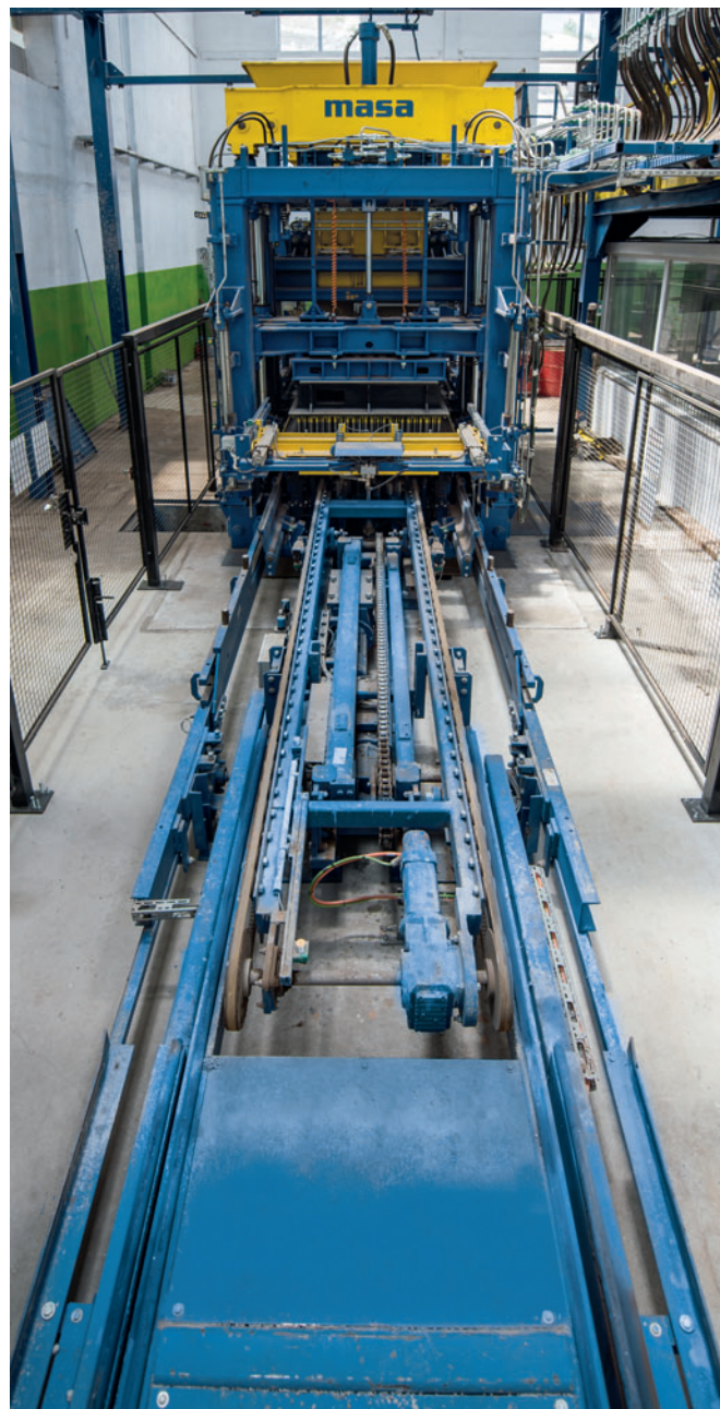
Fig. 1 : cœur de l'installation : la machine de béton de corps Masa XL 9.2 réglée en amplitude est équipée d'un paquet supplémentaire
