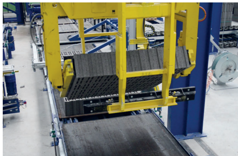
Fig. 4 : la cage de préhension du translateur de couche est équipée d'un dispositif de retournement vertical.
