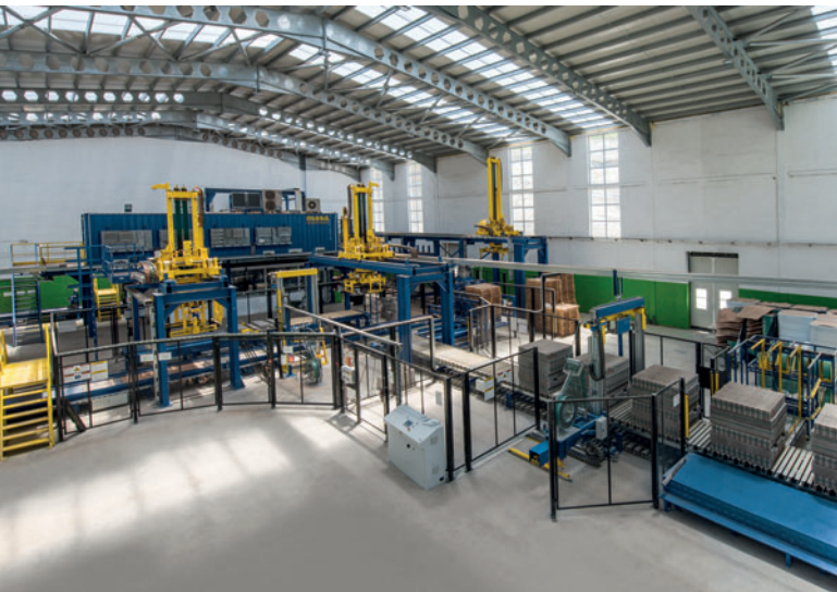
Fig. 2 : aperçu de la nouvelle ligne de regroupement : la zone de palettisation dispose du Masa Cuboter à hautes performances
