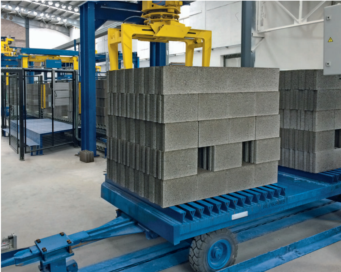
Fig. 6 : les paquets de blocs finis sont placés sur les chariots de transport, qui sont couplés à un convoyeur souterrain
