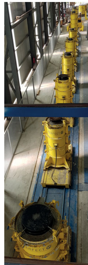
Los moldes llenos de camino a la zona de endurecimiento
