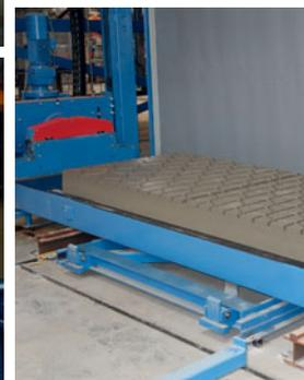
Fig. 5: Principio de la "plancha con huecos": a través de la mesa corrediza, un pisador y una mesa de separación se crean los "huecos".
