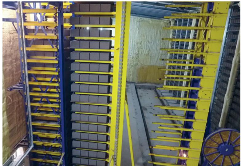
Fig. 3: El carro multiforca tampón Masa está acoplado al descensor sirve como almacén intermedio y evita tiempos de espera del carro multiforca.
