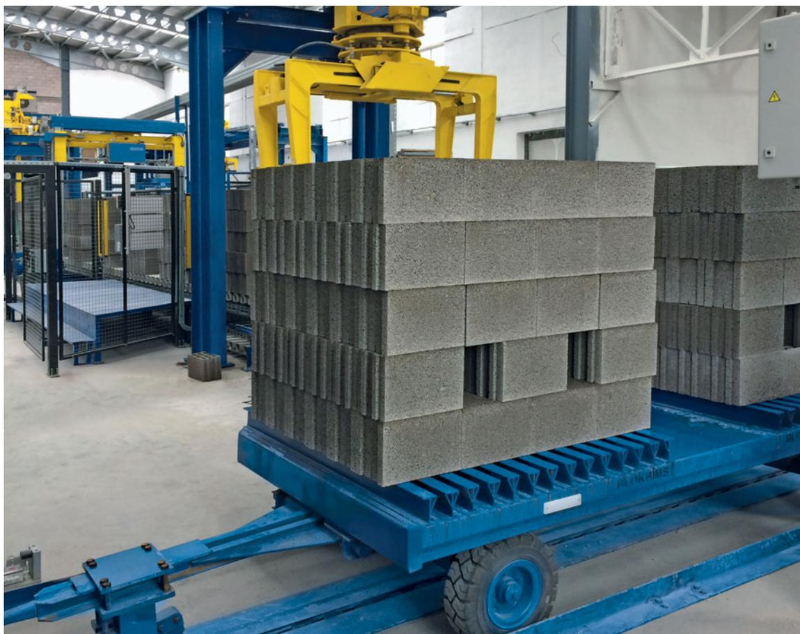
Fig. 6: Los paquetes listos se colocan sobre carros de transporte que están acoplados a una instalación de transporte subterránea
