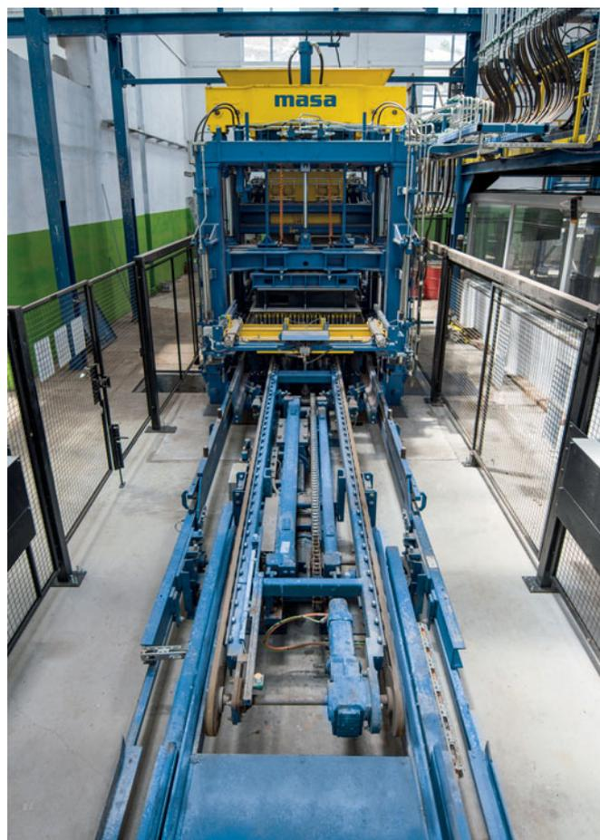
Fig. 1: La pieza principal de la instalación: La Masa XL 9.2 (máquina para hormigón monocapa) con regulación de la amplitud está equipada con un paquete adicional
