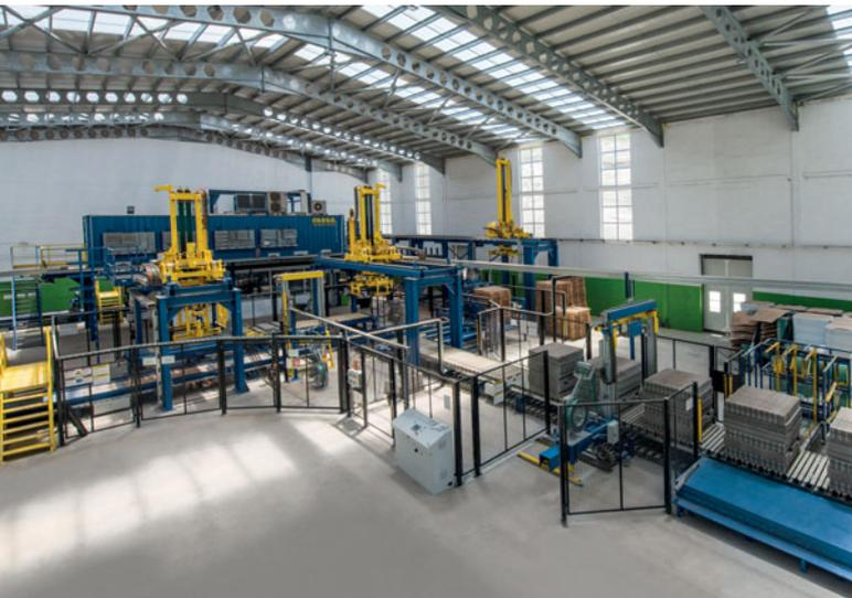
Fig. 2: Vista de la nueva línea de reordenación: la zona de empaquetado incluye la Masa Cuboter de alto rendimiento
