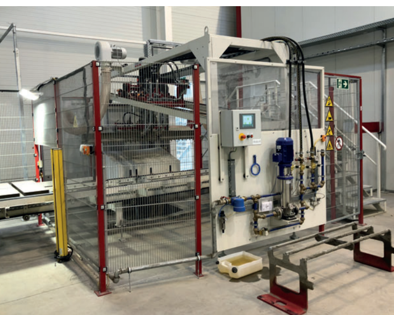
Mit einem neu entwickelten Waschgerät der Hess Group lassen sich die Produkte bereits auf der Nass-Seite veredeln.
