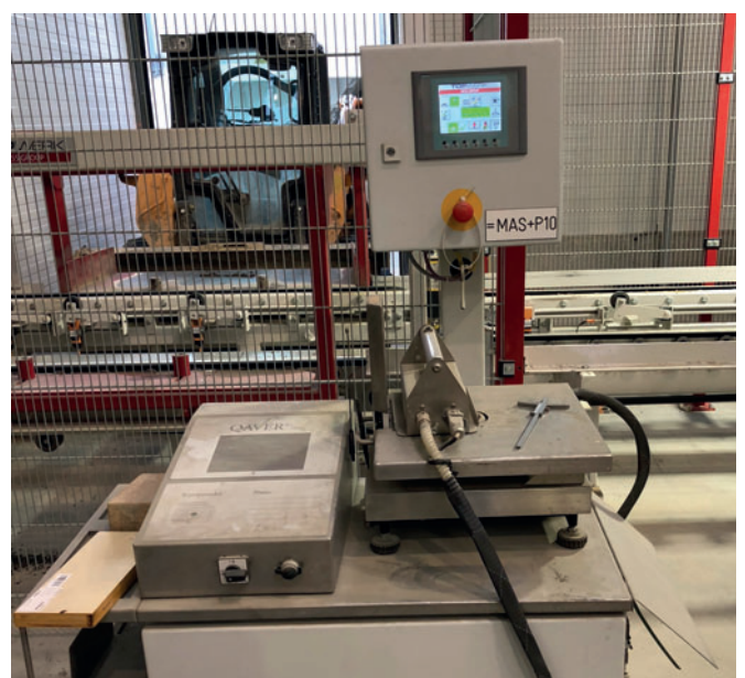
Mit dem Betonprüfgerät von Qavertec lässt sich die Qualität der erzeugten Produkte direkt ermitteln.
