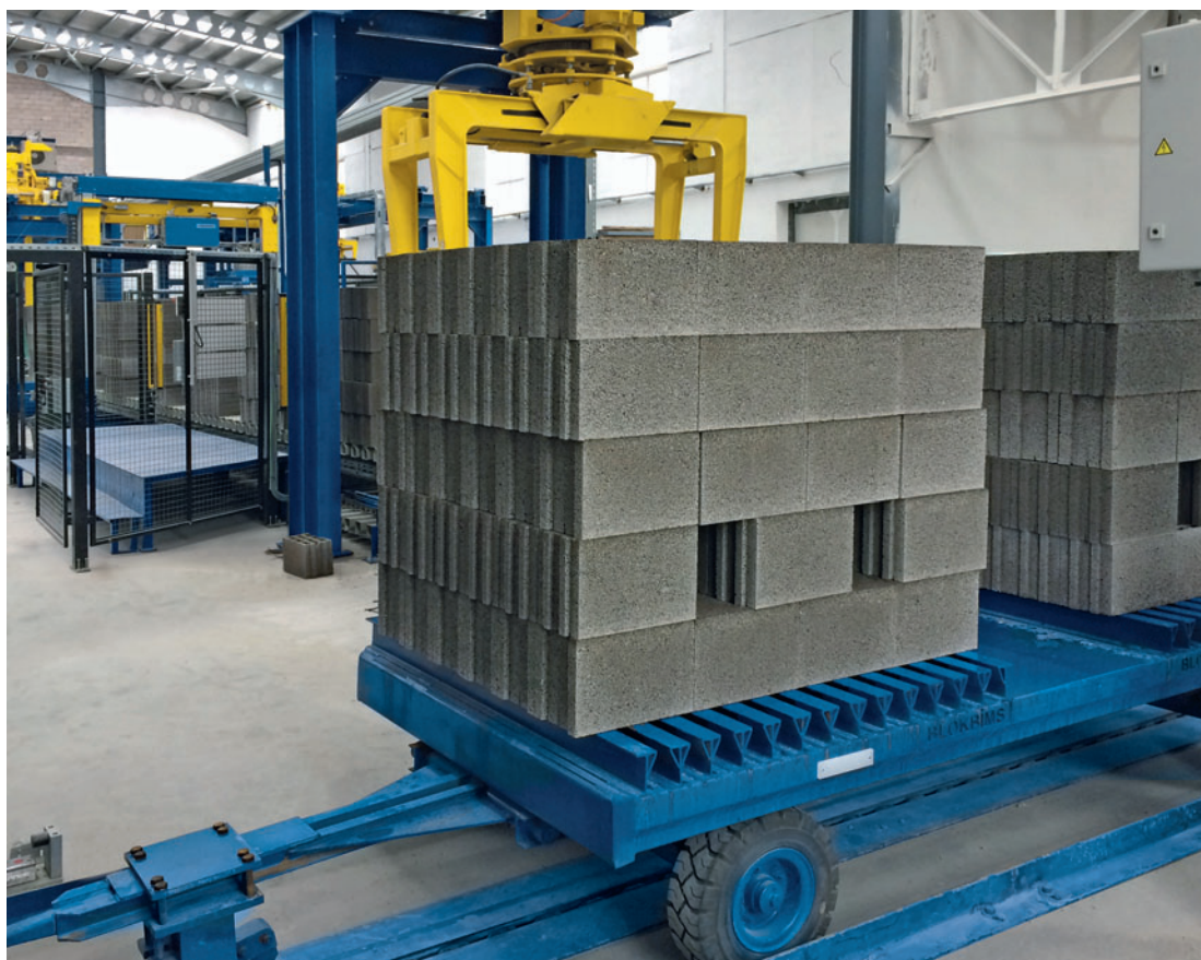
Abb. 6: Die fertigen Pakete werden auf Transportwagen gesetzt, welche an eine Unterflurförderanlage gekoppelt sind.
