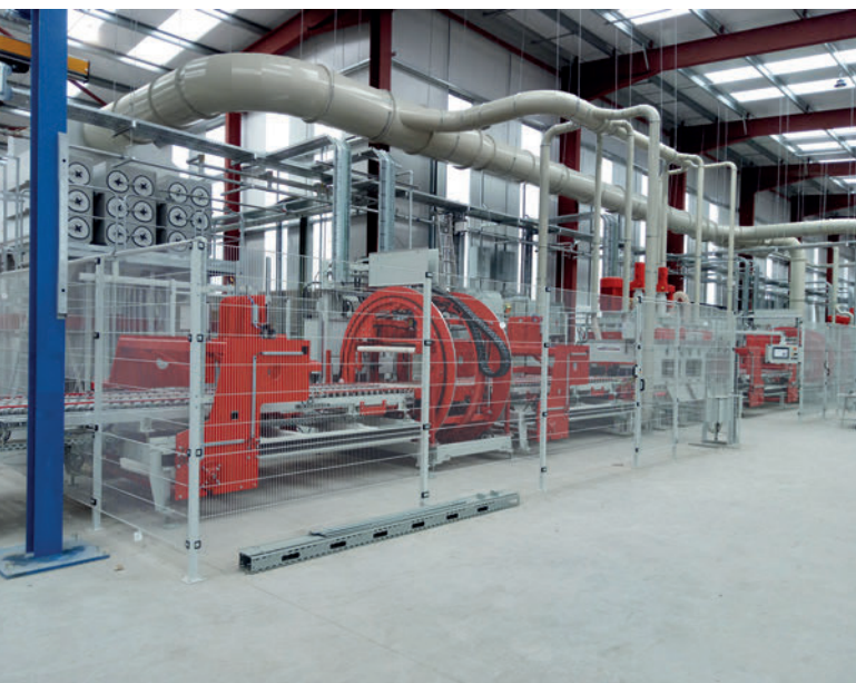
Пылеотсасывающее устройство марки Donaldson для калибровочного и шлифовального станка имеет пропускную способность 40 000 м 3
