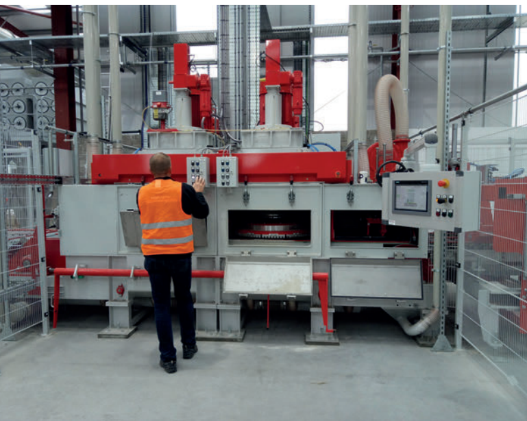
Калибровочная машина имеет две станции и работает в «сухом» режиме
