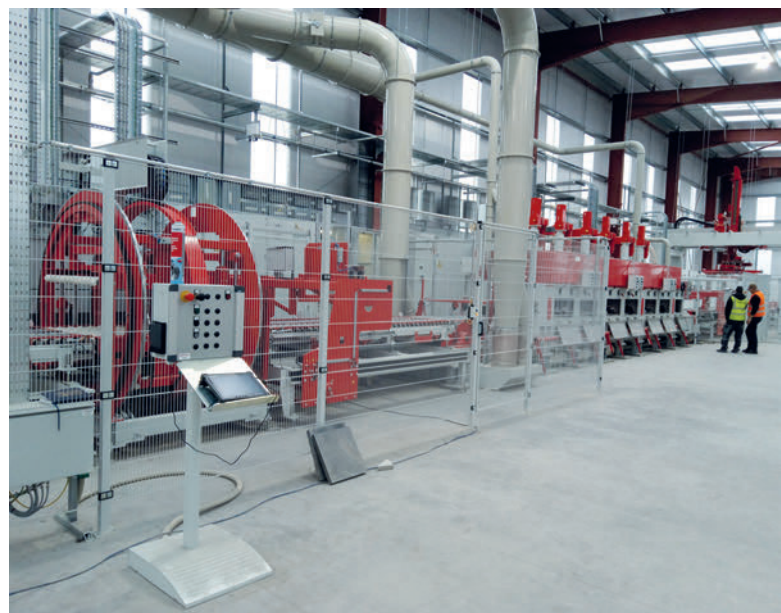
Кантователь барабанного типа повторно переворачивает изделия на 180° так, чтобы они поступали на обработку в шлифовальный станок лицевой стороной вверх
