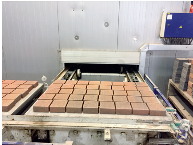
Многоцветная бетонная брусчатка покидает камеру для выдержки в течение 24 часов после производства
