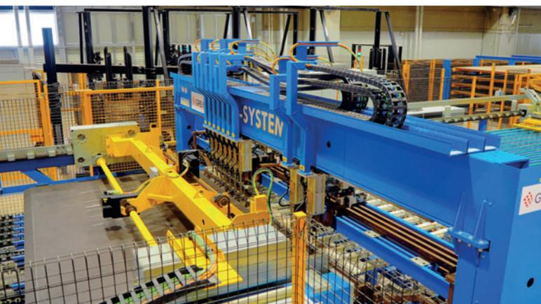
*L'armatura necessaria è prodotta al primo piano dell'edificio della fabbrica. L'impianto di saldatura reti M-System Evolution, sviluppato per una produzione il più possibile flessibile, si inserisce, quindi, in modo ottimale nel concetto totale.*
