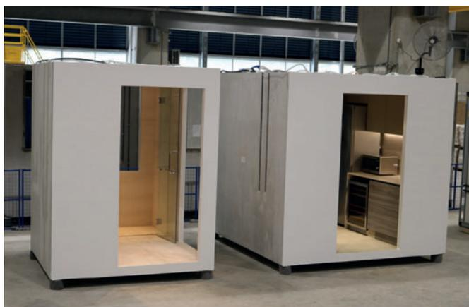
Il grado di prefabbricazione dei bagni e delle cucine prefabbricate arriva fino al 90 %, il che consente di ridurre notevolmente non solo il tempo necessario per l'installazione, ma anche i costi.
