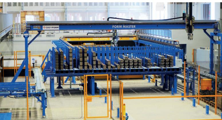
*L'impianto a carosello di pallet, altamente automatizzato, (nella figura il robot di posizionamento e rimozione fermagetti) consente a Greyform di rispettare tempi di consegna precisi e massimi requisiti qualitativi con poco personale.*
