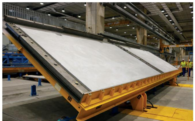
*Al termine del ciclo di produzione, le pareti massicce oppure i solai pieni, prefabbricati, sono prelevati da uno dei 48 pallet e trasportati automaticamente al magazzino.*
