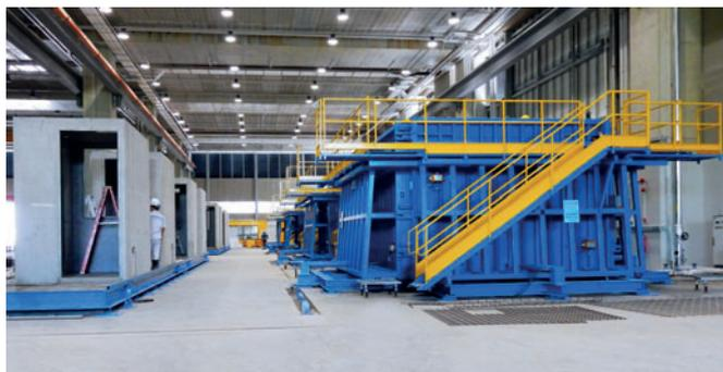
Con l'ausilio di quattro casseri 3D, Greyform produce moduli stanza, utilizzati per realizzare cucine e bagni prefabbricati.
