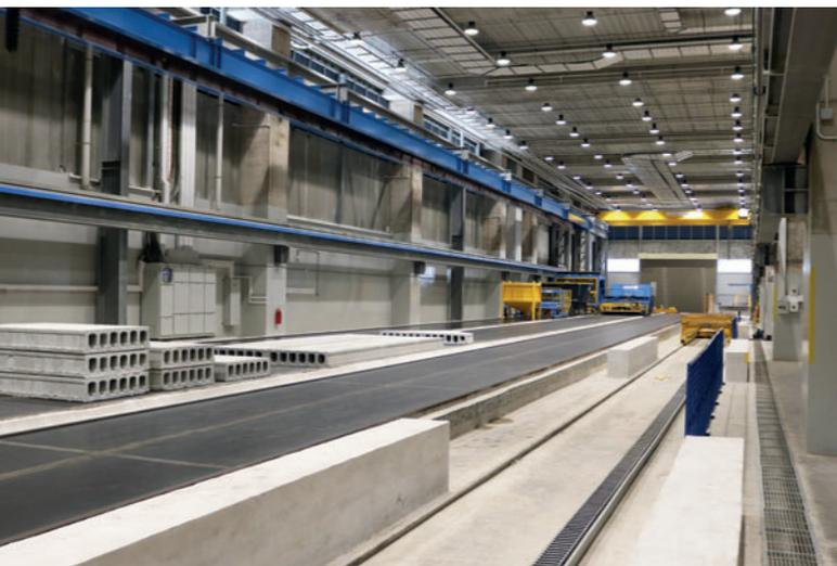
*Per produrre i solai alveolari precompressi e gli elementi precompressi, Greyform impiega una vibrofinitrice del tipo S-Liner T40 su tre piste.*
