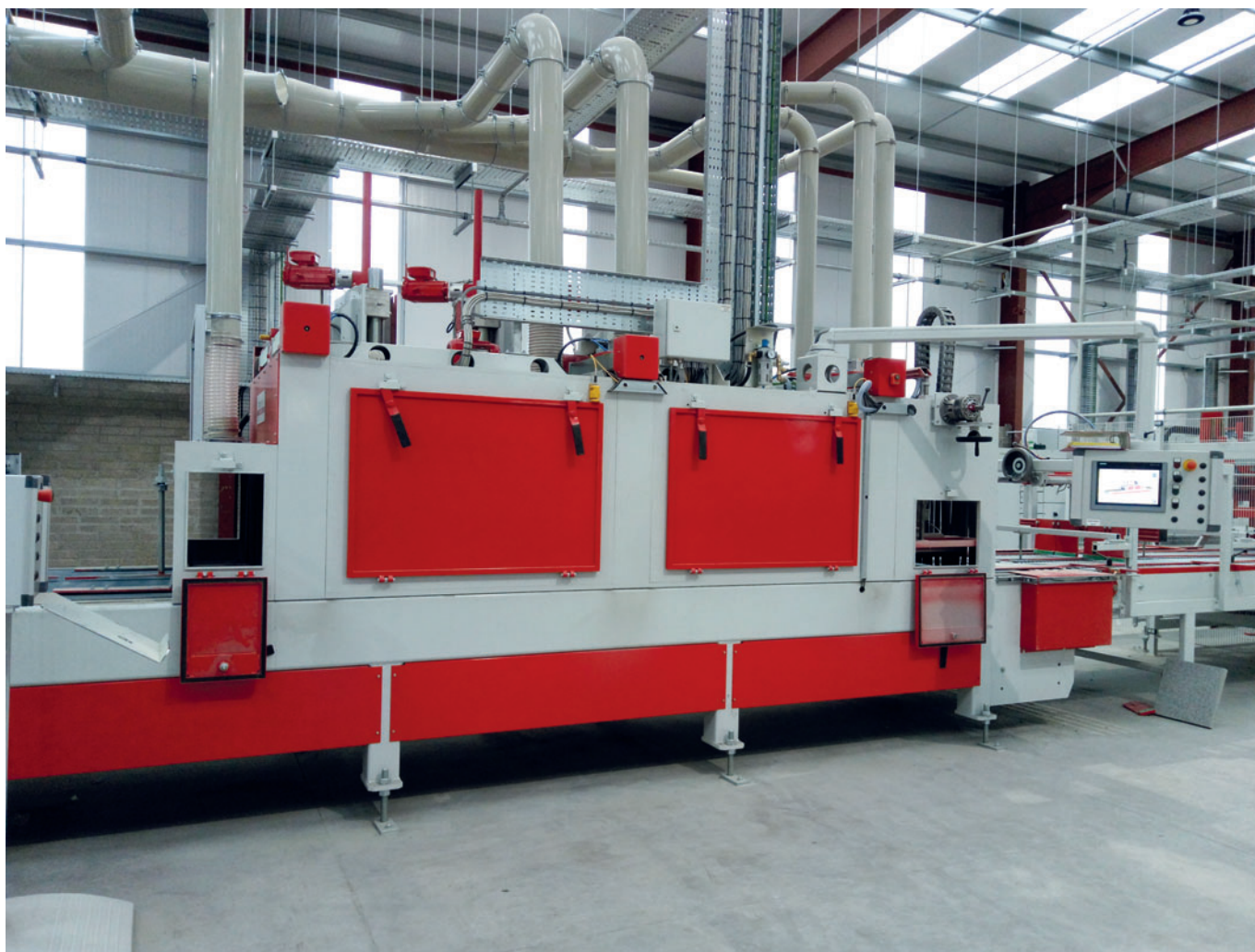
Anche nella macchina a spazzole, nel funzionamento a impulsi, le guide laterali sono impostabili elettricamente su larghezze di prodotto differenti.
