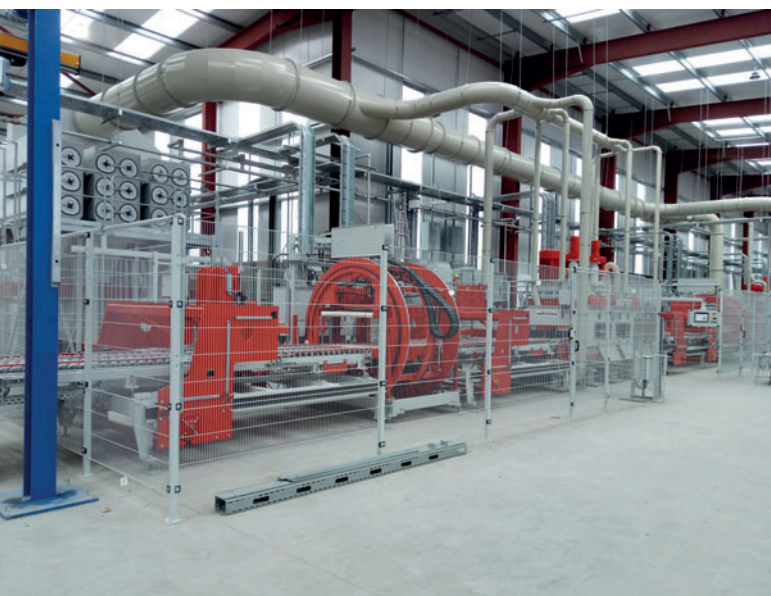
L'aspirazione di polveri per la calibratrice e rettificatrice è concepita per una portata in volume pari a 40.000 m 3
