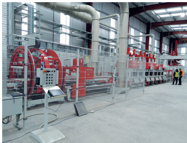
Il volteggio a tamburo volta nuovamente i prodotti di 180° e i pezzi entrano nella rettificatrice con il lato di rivestimento rivolto verso l'alto.
