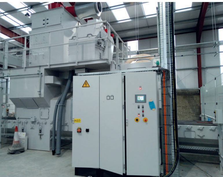
Nella sabbiatrice si lavorano i prodotti a strati con la graniglia, a una distanza minima di 600 mm, tramite due turbine da 18,5 kW
