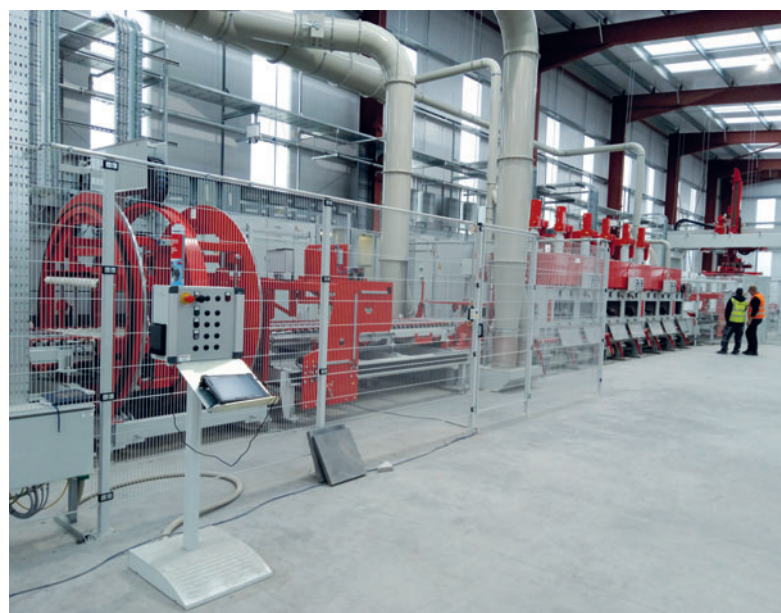
Le rouleau inverseur retourne à nouveau les produits de 180° et les pièces usinées sont introduites avec la face parement vers le haut dans la meuleuse.
