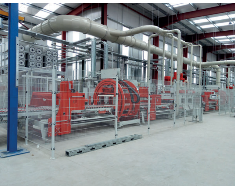
L'aspiration des poussières pour la machine à calibrer et la meuleuse est conçue pour un débit de 40 000 m 3
