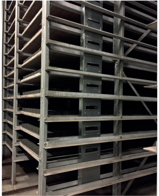
Sorties de circulation d'air à chaque niveau de la chambre de durcissement pour permettre à l'air de circuler lentement et de manière très uniforme. Ce projet comprend un total de 14 puits verticaux avec 308 sorties de circulation d'air et 64 entrées de reflux.
