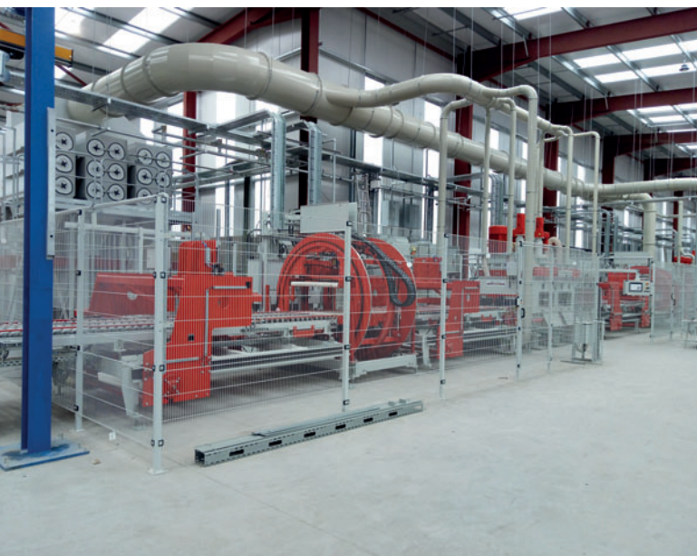
El sistema de aspiración de polvo para la máquina de calibración y rectificación fue diseñado para un caudal volumétrico de 40.000 m 3
