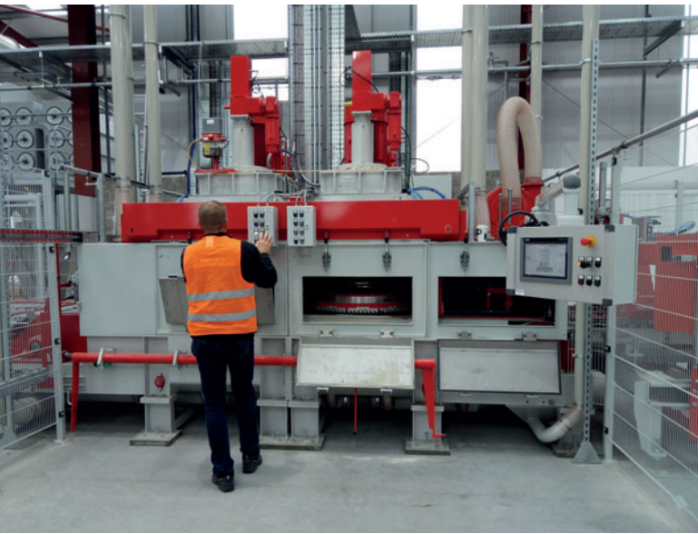
La máquina de calibración con dos estaciones trabaja por procedimiento en seco
