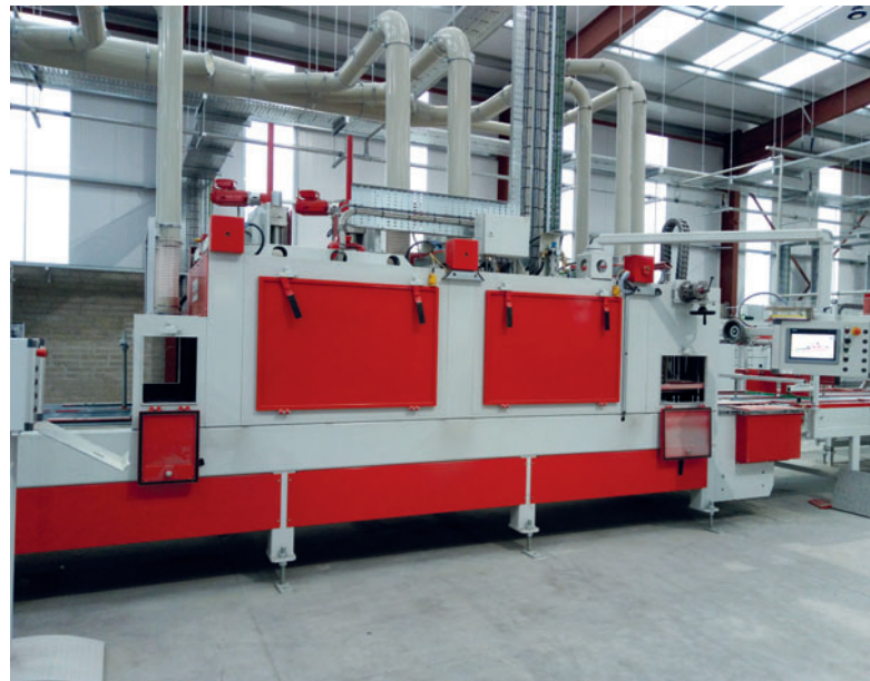
También en la máquina de curling, las guías laterales se pueden ajustar eléctricamente por impulsos a diferentes anchuras de producto.
