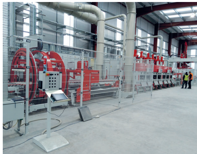
El tambor de volteo vuelve a girar los productos 180° y las piezas se desplazan con el lado exterior hacia arriba a la máquina rectificadora.
