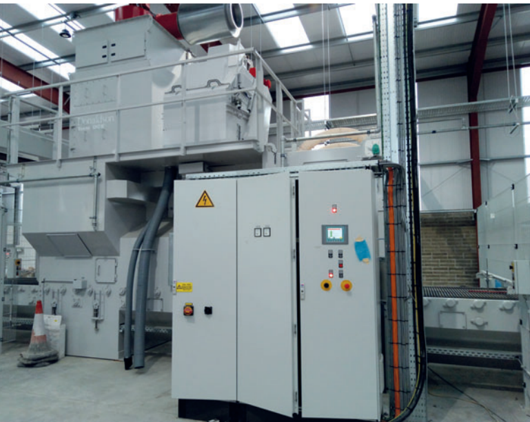
En la máquina de granallado, los productos son procesados con granalla en capas con una separación mínima de 600 mm mediante dos turbinas de 18,5 kW cada una
