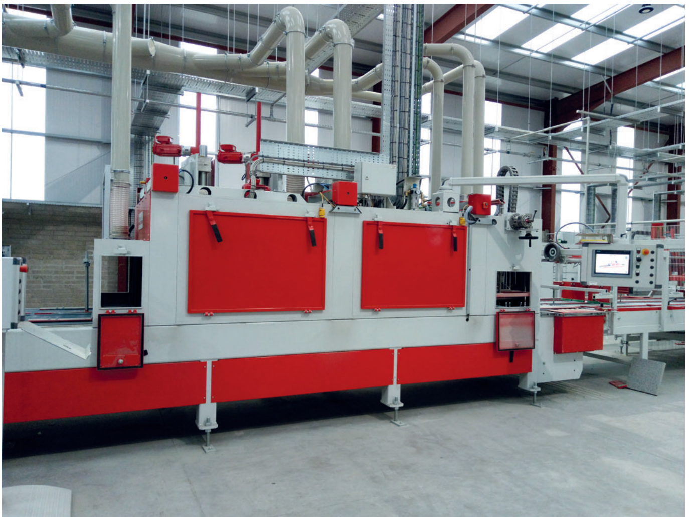
Auch in der Curlingmaschine sind die Seitenführungen im Tippbetrieb elektrisch auf unterschiedliche Produktbreiten einstellbar.
