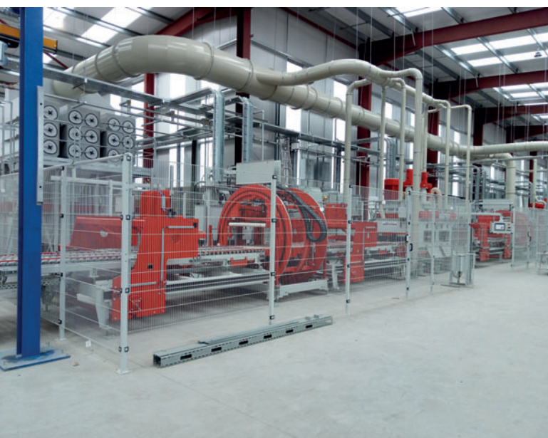
Die Staubabsaugung für die Kalibrier- und Schleifmaschine ist auf 40.000 m 3 Volumenstrom ausgelegt.
