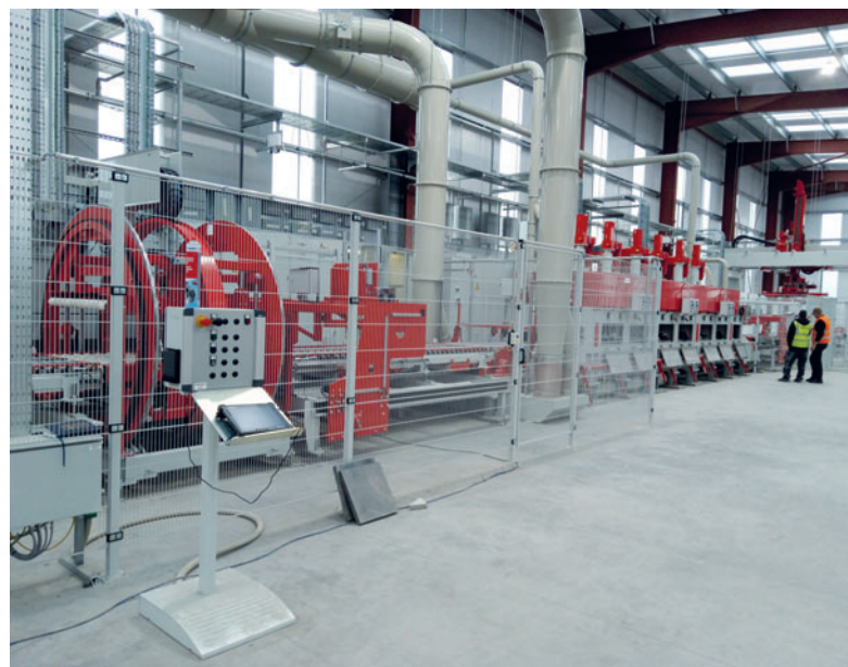
Der Trommelwender wendet die Produkte erneut um 180°, und die Werkstücke fahren mit der Vorsatzseite nach oben in die Schleifmaschine.
