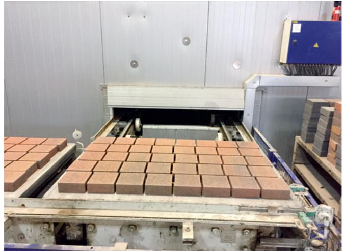
*Ausgehärtete gescheckte mehrfarbige Pflastersteine verlassen die Aushärtekammer innerhalb von 24 Stunden nach der Produktion*
