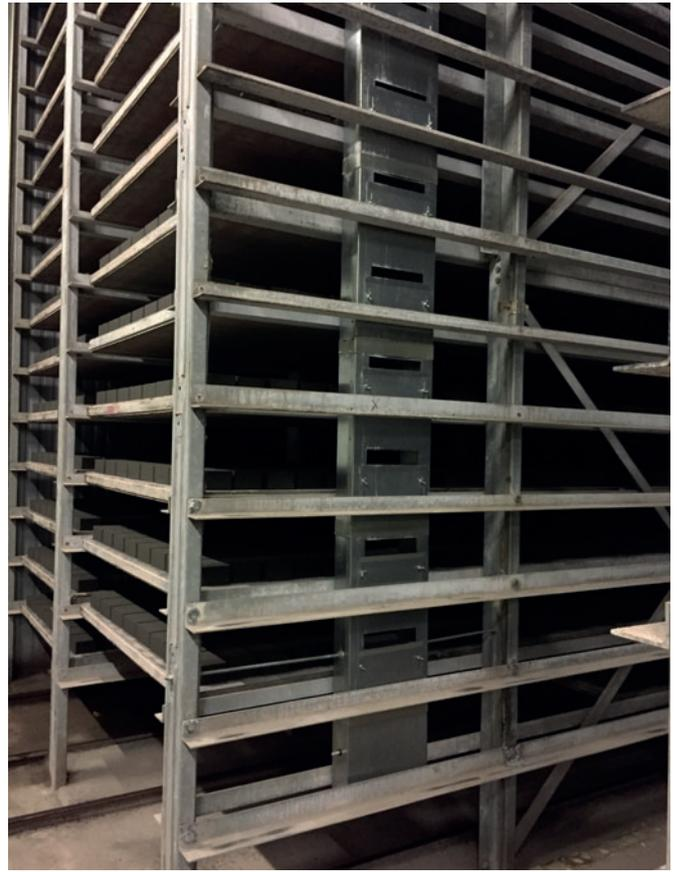
Luftzirkulationsausgänge auf jeder Ebene der Aushärtekammer, damit die Luft langsam und sehr gleichmäßig strömt. Dieses Projekt weist insgesamt 14 senkrechte Schächte mit 308 Luftzirkulationsausgängen und 64 Rückströmungseingängen auf.
