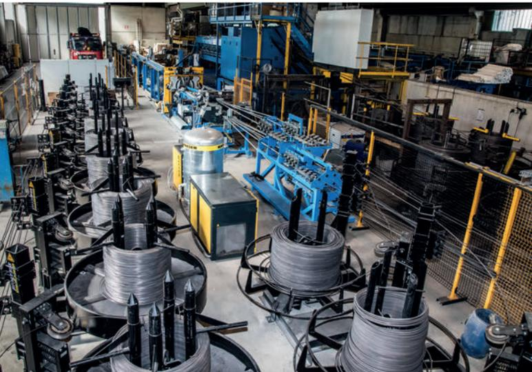
На новой установке VGA Versa выпускаются решетчатые балки высотой до 650 мм, необходимые для производства двойных стеновых панелей и плит перекрытий
