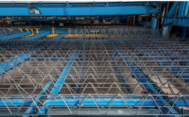
Высота балки и диаметр проволоки во время производства регулируются в плавном режиме
