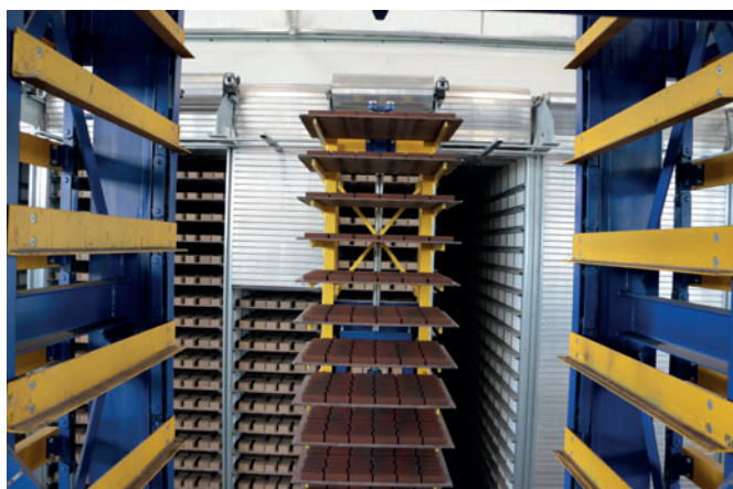
Manufatti appena prodotti alla consegna all'elevatore
