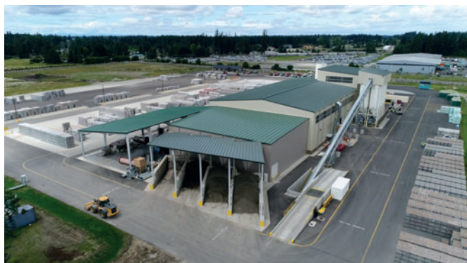
Vicino alle postazioni coperte di stoccaggio per le materie prime all'esterno, tramite una stazione di caricamento del materiale con nastro in salita vengono caricati gli otto silos
