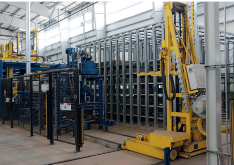
Il sistema tampone per circa 2000 pallet di produzione con scaffalatura di immagazzinamento e carrello di trasporto
