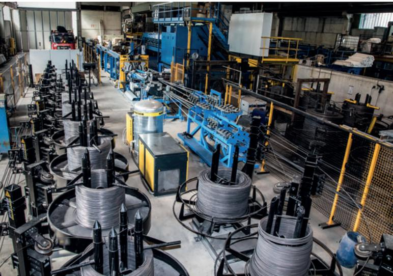
Grâce à la nouvelle installation VGA Versa, l'entreprise fabrique en interne tous les raidisseurs nécessaires à la production de doubles parois et de prédalles, dont la hauteur peut atteindre 650 mm.
