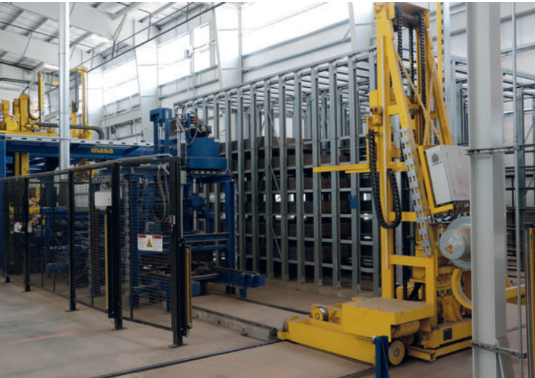
El sistema tampón para aprox. 2000 bandejas de producción con estante de almacenamiento y carro de transporte
