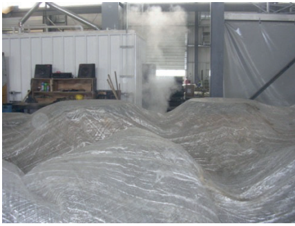
Prefabricados de hormigón tratados con vapor debajo de una lona
