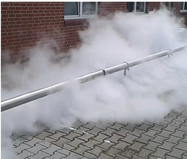
Vaporverteilungsleitung mit Löcher- oder mit Schlauchanschluss zur Wärmeverteilung.
